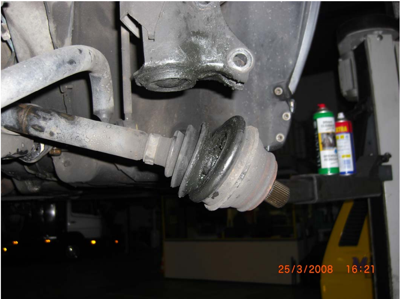
Abb.1: Freigelegte Antriebswelle mit defekten Faltenbalg
