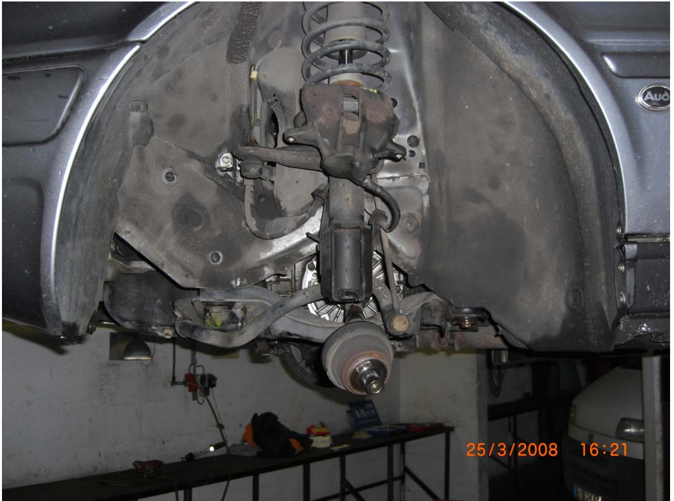
Abb.2: Radhaus ohne Bremsanlage, Radlager und Querlenker
