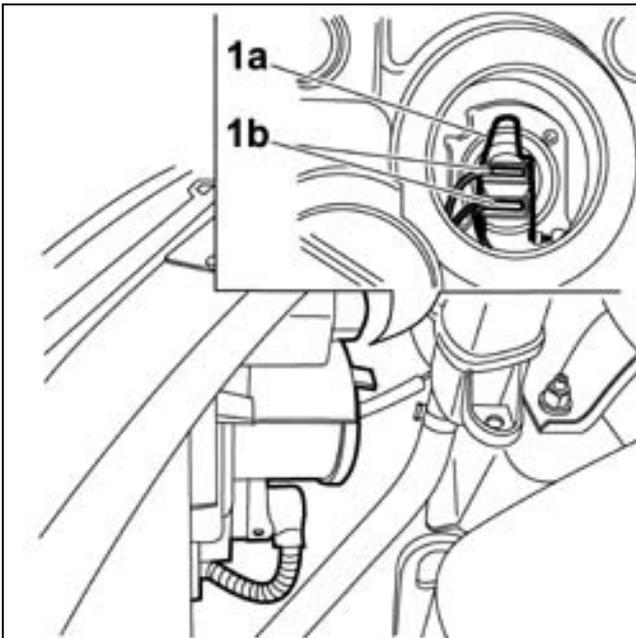
1. Den Federbügel (1a) aushaken, die elektrischen Verbindungen (1b) abklemmen und die Lampe herausnehmen.
