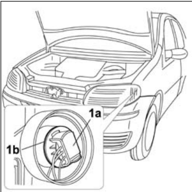
1. Den elektrischen Anschluss (1a) drehen, aus seinem Sitz (1b) ziehen und die Lampe entfernen.
