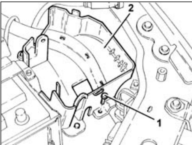
1. Befestigungsschraube des Gehäuses des Verteilers heraus schrauben.
