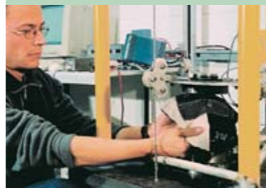
ADAC-Versuchsleiter Ruprecht Müller prüft die Belastbarkeit von Protpektoren
