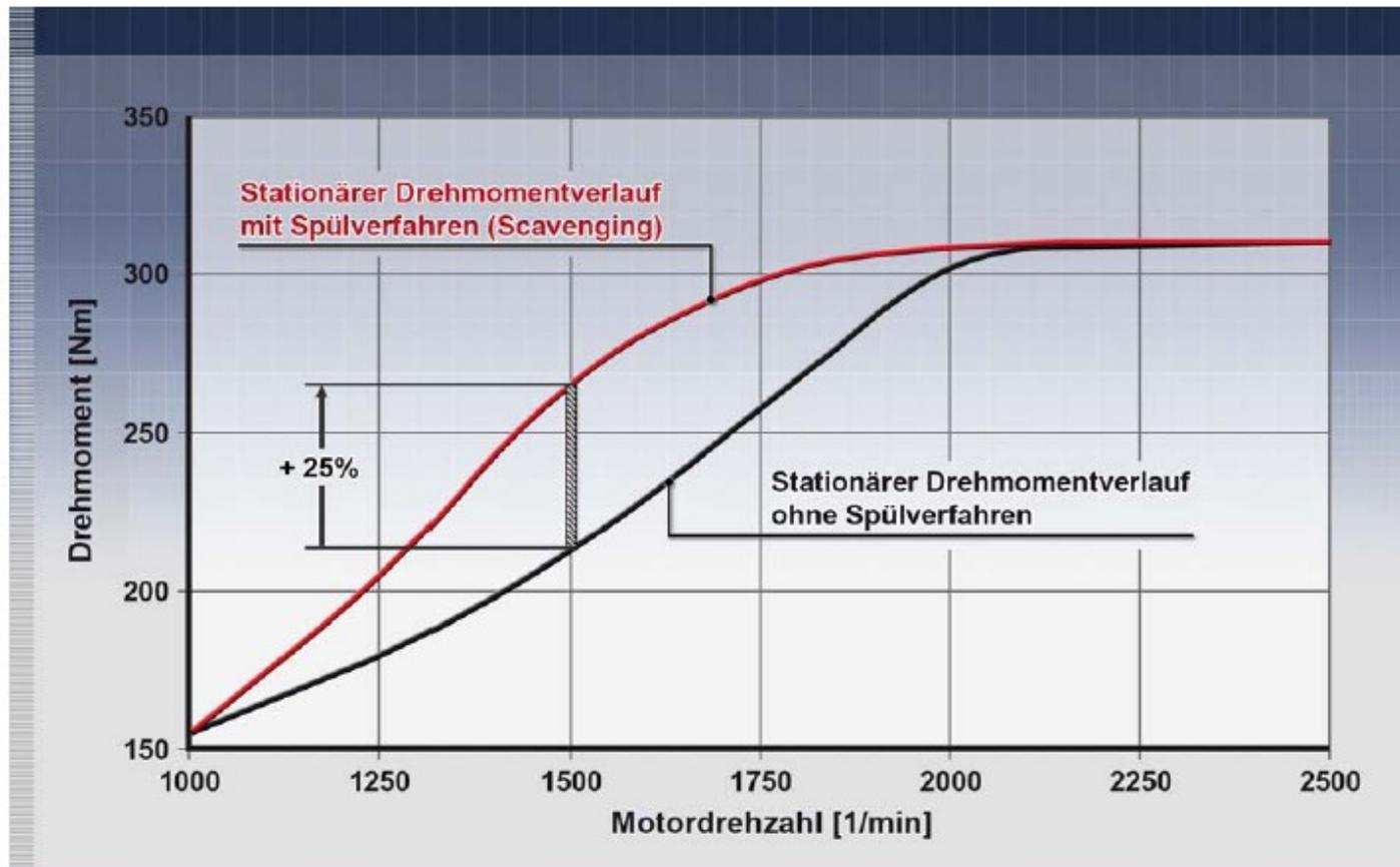
Abb. 9: Stationäre Drehmomenterhöhung durch "Scavenging"
