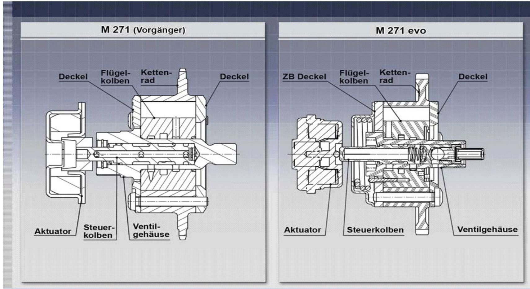
Abb. 3: Nockenwellenversteller M 271 evo im Vergleich zum Vorgängermotor
