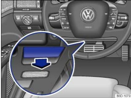
Abb. 009 Im Fahrerfußraum: Entriegelungshebel für den Sicherungskasten.
