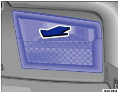
Abb. 007 Im Gepäckraum rechts: Staukasten ausbauen.
