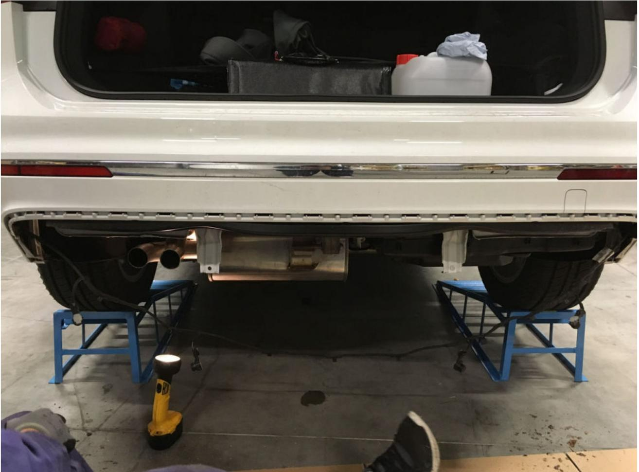
Am neuen Diffusor: Markierte Löcher für die PDC-Sensoren bohren und Einbau der Original PDC-Sensoren.
