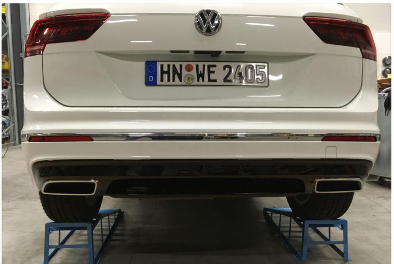
Ausbau Diffusor von Stoßstange: Unten am Rand des Diffusor 4 Schrauben entfernen (Links, Mitte, Mitte, Rechts), dann die Spreiz-Klipps entfernen. Anschließend Diffusor ausklippsen.
