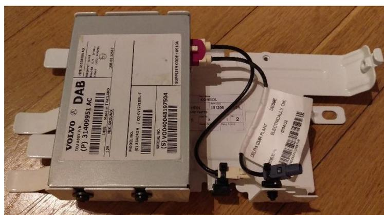
Das Modul kann mithilfe der Adapterplatte einfach hinter, unterhalb des mittleren Sitz eingeklickt werden.
