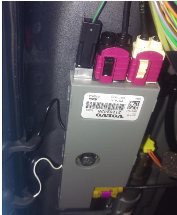
Der bestehende Antennenverstärker wird einfach durch den mit dem DAB Ausgang **31282428** ersetzt.
