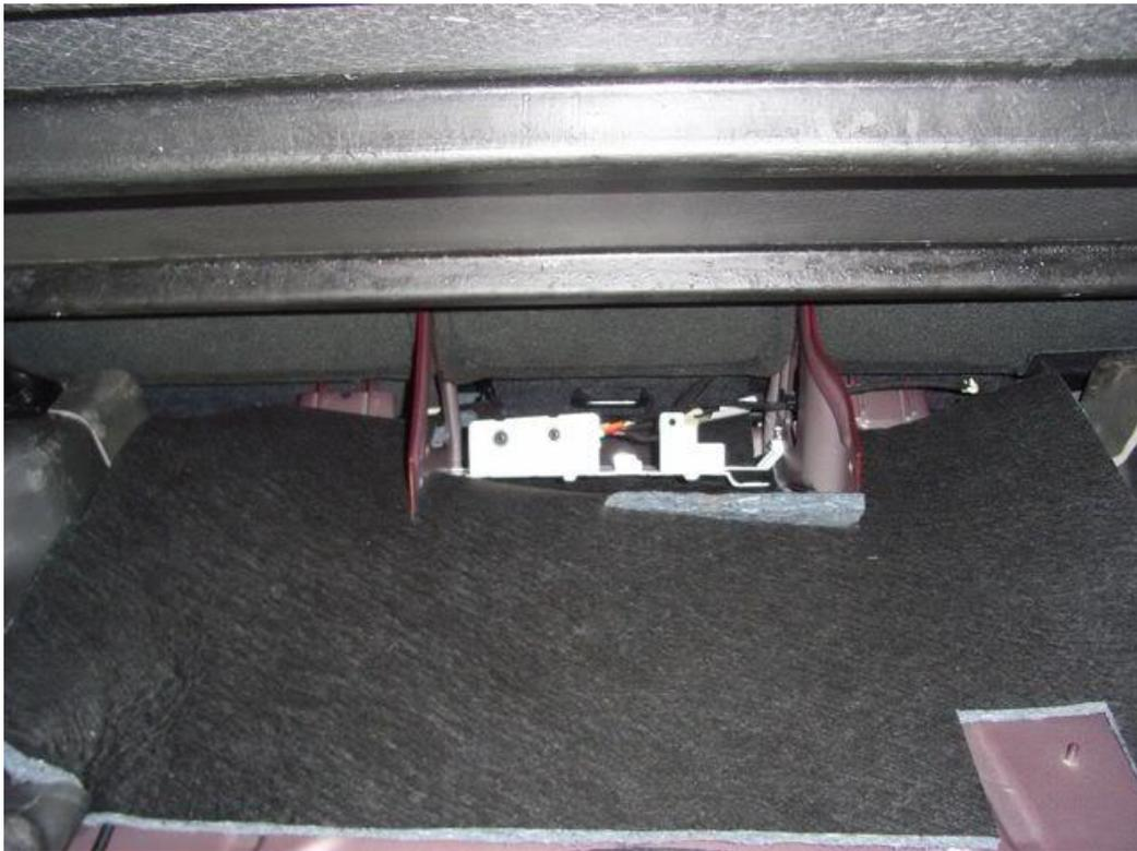
Zusätzlich braucht es noch ca. 2x 2,5m verschieden farbiger 1mm<sup>2</sup> Litzenkabel um das DAB Modul mit Strom zu versorgen. Die Stromversorgung für das DAB Modul habe ich vom hinteren Sicherungskasten (REM auf der linken Seite im Kofferraum, genau oberhalb des RTI Rechners). Da gibt es noch unbelegte Plätze die aber bereits auf der einen Seite mit Strom versorgt werden. Bei mir war das der Platz Nummer 4 und 6.
