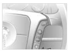
Die Lenkradheizung funktioniert in Zündschlüsselstellung 2. Zum Ein- und Ausschalten die Taste (Pfeil) drücken.
