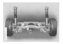
Die Lenker der patentierten Integral Hinterachse aus Aluminium sind nicht direkt an der Karosserie befestigt. Sie sind elastisch in einem sogenannten Fahrschemel gelagert, der wiederum elastisch mit der Karosserie verbunden ist. Bereits kleinste Fahrbahnunebenheiten werden so mit dieser doppelelastischen Lagerung absorbiert.
