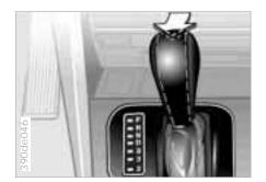
Eine Sperre verhindert das versehentliche Schalten in einige Wählhebelpositionen. Um die Sperre aufzuheben, die Taste an der Vorderseite des Wählhebelknaufs drücken (Pfeil).
