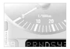
Das Automatic-Getriebe Ihres BMW ist mit einer Adaptiven Getriebesteuerung AGS ausgerüstet, die feinfühlig auf Ihre individuelle Fahrweise, die Fahrsituation, den Straßenzustand und die Verkehrsverhältnisse reagiert. Dafür werden automatisch verschiedene Fahrprogramme verwendet, z.B. ist auch ein "Winterprogramm" vorhanden.
