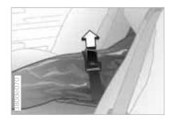
Die verstauten Skier oder sonstigen Gegenstände mit dem am Skisack befindlichen Haltegurt durch Straffen an der Spannschnalle sichern.
