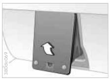
4 Vom Kofferraum aus die Ladeklappe mit den Magnethaltern an der Unterseite der Hutablage befestigen.
