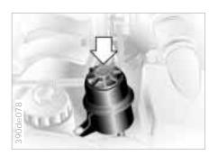
Bei stehendem Motor den Behälterdeckel aufschrauben und den Deckel mit dem Meßstab wieder einstecken.
