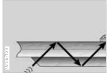
Der Regensensor – in Verbindung mit der Ausstattung Scheinwerfer-Waschanlage – steuert je nach Benetzung der Windschutzscheibe den Scheibenwischerbetrieb.
