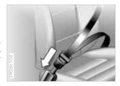
Der Gurtschloßstrammer sorgt dafür, daß bei einer Kollision der Gurt deutlich fester anliegt und den Körper sicher im Sitz hält. In Sekundenbruchteilen wird das Gurtschloß mit Hilfe von Gasdruck zurückgezogen, Schulter und Beckengurt werden dadurch gleichzeitig gestrafft. So wird dem Durchrutschen unter dem Beckengurt hindurch entgegengewirkt.
