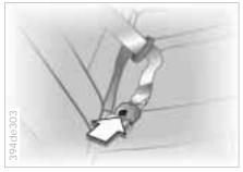
Der mittlere Gurt hat ein zusätzliches kleines Trennschloß.
