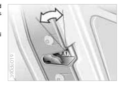
An einer Fondtür Schlüssel in den Schlitz stecken und nach außen drehen: Die jeweilige Tür kann nur von außen geöffnet werden.
