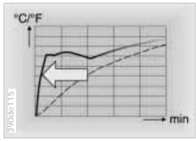
Der Latentwärmespeicher speichert Motorwärme selbst bei extrem niedrigen Außentemperaturen über Tage. Nach dem Motorstart kann diese gespeicherte Wärme dann unmittelbar genutzt werden, um die Frontscheibe und die Seitenscheiben abzutauen und von Beschlag zu befreien. Auch werden die Zeiten für das Aufheizen des Innenraums und die Warmlaufphase des Motors wesentlich reduziert (Pfeil).
