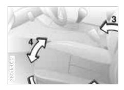
3 Lehne Den Hebel ziehen und die Lehne nach Bedarf belasten oder entlasten
