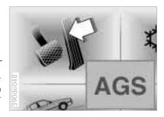
Die Adaptive Getriebesteuerung AGS errechnet für Fahrzeuge mit Automatic-Getriebe aus einer Vielzahl von Faktoren die jeweils bestmögliche Gangwahl. Sie berücksichtigt dabei Ihre individuelle Fahrweise, die Fahrsituation, den Straßenzustand und die Verkehrsverhältnisse.
