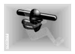
Verzögerungssensoren überprüfen laufend die auf das Fahrzeug wirkenden Beschleunigungen. Wird aufgrund eines Frontalaufpralls eine Verzögerung erreicht, bei der die Schutzwirkung der Sicherheitsgurte alleine nicht mehr ausreichen würde, werden die Gasgeneratoren von Fahrer- und Beifahrerairbag parallel gezündet. Der Beifahrerairbag wird jedoch nur dann ausgelöst, wenn ein weiterer Sensor erkannt hat, daß sich eine Person auf dem Beifahrersitz befindet.
