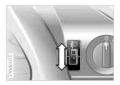
Um den Gegenverkehr nicht zu blenden, muß die Leuchtweite des Abblendlichts der Fahrzeugbeladung angepasst werden:
