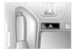
Die Drucktaste leuchtet bei eingeschalteter Warnblinkanlage periodisch auf.
