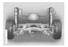
Die Niveauregulierung für die Hinterachse hält die Bodenfreiheit Ihres Fahrzeugs auch bei Beladung konstant.
