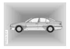
In der Nähe eines jeden Rades befindet sich in der Karosserie eine Antenne, die die Signale von allen vier Rädern empfängt. Eine zentrale Elektronik wertet die vierfach empfangenen Signale aus und meldet Veränderungen weiter.
