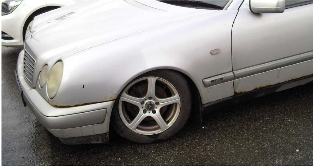
Abbildung 2: Gebrochene Federaufnahme an einem schrecklich vergammelten 210er. Das Fahrzeug hängt auf den Rädern und wäre so nicht mehr während der Fahrt kontrollierbar.
