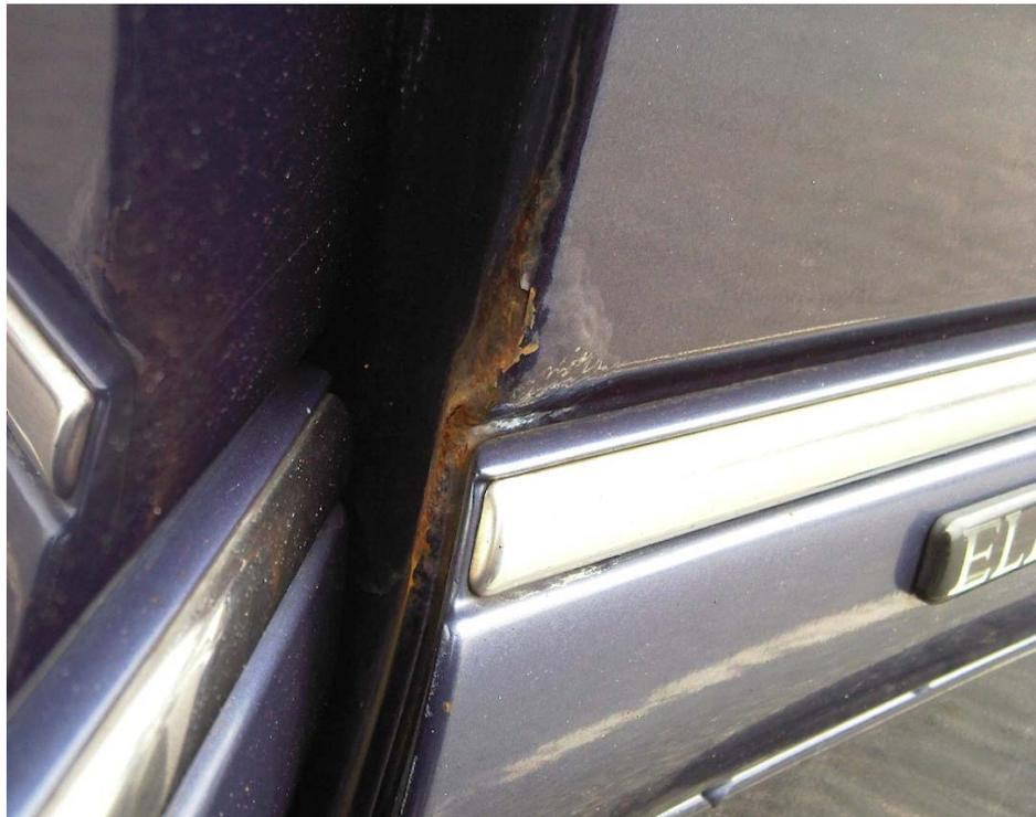
Abbildung 7: Rost am rechten Kotflügel zur Türöffnung
