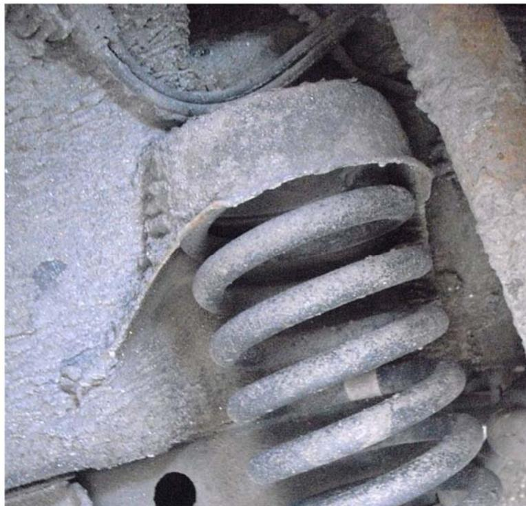
*Abbildung 4: Verdreckte Federaufnahme: Hier lässt sich keine Beschädigung erkennen*
