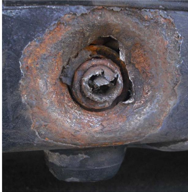
*Abbildung 6: Durchgerostete Wagenheberaufnahme bei einem Vor-Mopf 210er*
