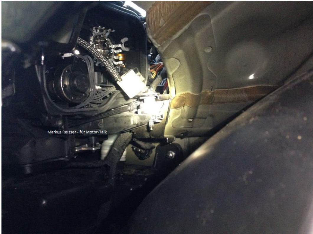
Jetzt einfach den neuen Xenonbrenner nehmen und den grauen Stecker (Spannungsversorgung) wieder anstecken. Danach den Brenner wieder von hinten gerade in den Scheinwerfer stecken. Diese silbernen Halteklemmen kann man ja gut in Bild 6 erkennen. Der Metallstift des Xenonbrenners muss übrigens nach unten zeigen - eben so, wie man den Brenner auch beim Ausbau vorgefunden hat 🤔
