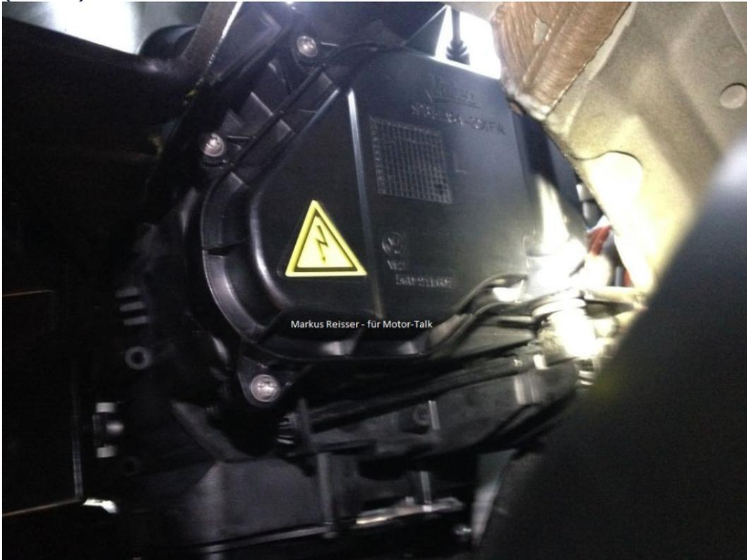
Im Motorraum sind es 2 Schrauben und "im Raum der Radhauschale" sind es 3 Schrauben.
