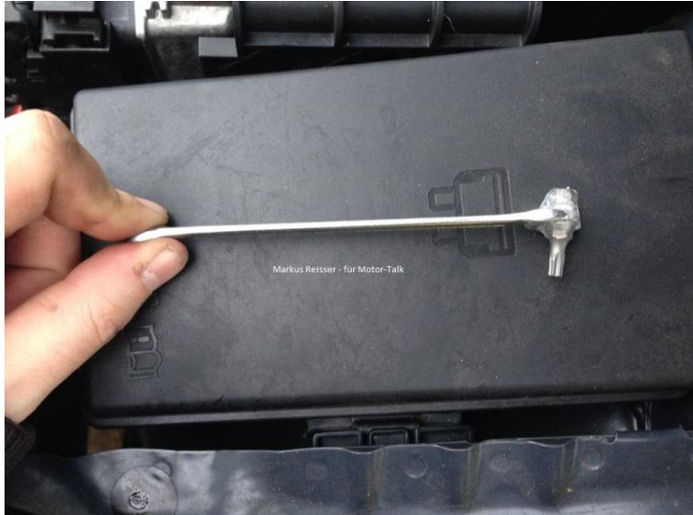
Einfach einen kleinen Schraubenschlüssel mit einem T-20 Bit versehen - etwas schräg und dann verschweißen oder kleben.
