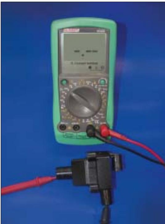
Zur Messung der Sekundärspule Prüfspitzen direkt an den Hochspannungsausgängen der Zündspule messen.
