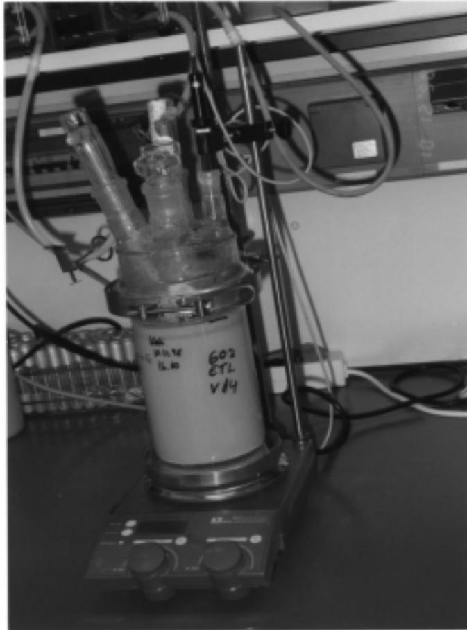
Abb. 14: Versuchsaufbau der Fed Batch Prozeßführung im 1,3 l Glasfermenter mit aus der Vorbehandlung isolierten Mikroorganismen. Überprüfung einer möglichen Adaptation an silberhaltigen Elektrotauchlack, sukzessive Erhöhung des Lackanteils ( $AV = 1 \text{ l}$ ,  $D = 0,0041 \text{ h}^{-1}$ ,  $30^\circ\text{C}$ ,  $250 \text{ rpm}$  auf dem Heizrührer)
