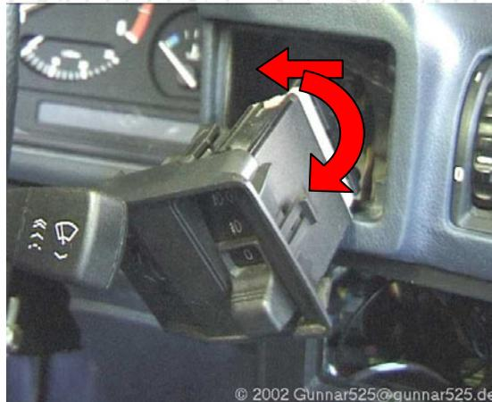
Abbildung 53: Schalter Nebel & Leuchtweitenregulierung
