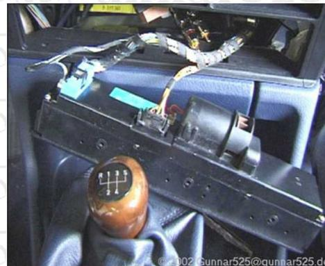
**Abbildung 20: Kabel Klimaautomatikbedienteil**
