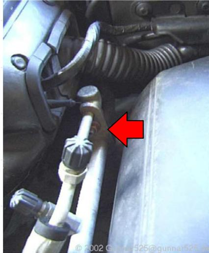
**Abbildung 74: Klimaleitungen Befüllanschlüsse**
