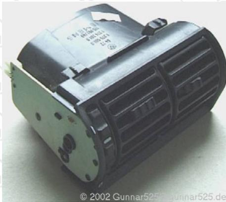
**Abbildung 8: Luftdüse Fond elektrisch**
