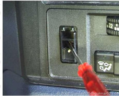
**Abbildung 19: Verriegelung Klimaautomatik-Bedienteil**
