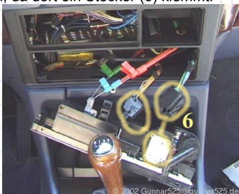
**Abbildung 17: Heizung- / Klima-Bedienteil**
