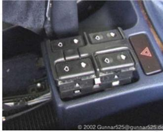
**Abbildung 26: Fensterheberblock Mittelkonsole**
