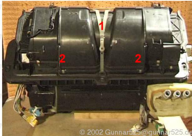
**Abbildung 64: Deckel zum Gebläsemotor**
