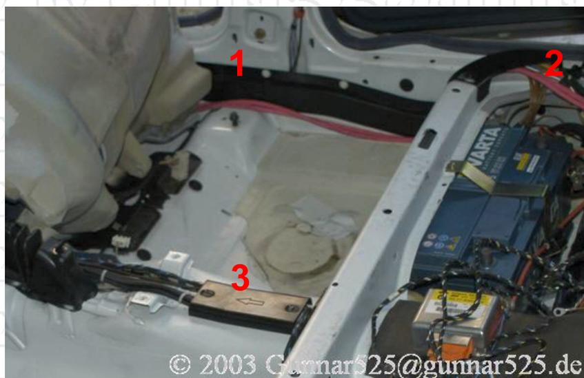
**Abbildung 83: Kabelkanäle unter hinterem Teppich**
