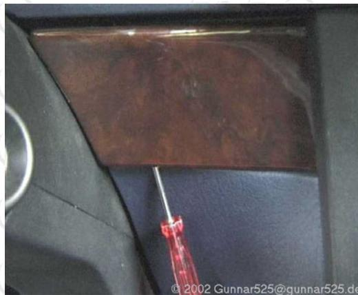
**Abbildung 36: Ausbau Holz rechts der Lenksäule**
