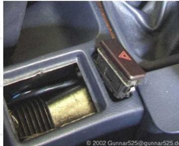
**Abbildung 27: Warnblinkschalter**
