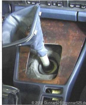
**Abbildung 23: Schalthebelabdeckung**
