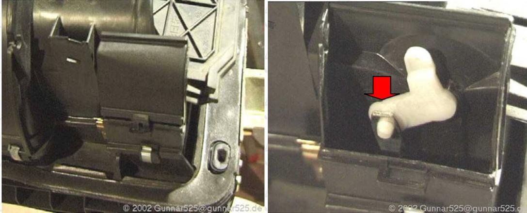
**Abbildung 66: Ansteuerung Frischluftklappen**
