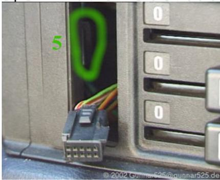
**Abbildung 16: Verriegelung Heizung- / Klima-Bedienteil**
