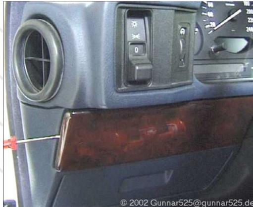
**Abbildung 35: Ausbau Holz links der Lenksäule**
