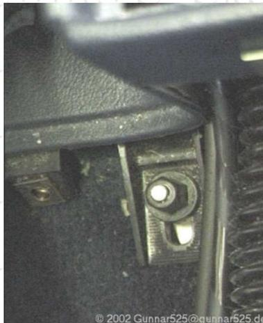
**Abbildung 9: Schraube vordere Mittelkonsole beim Handbremshebel**
