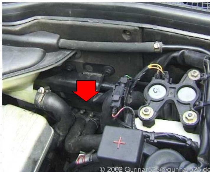
**Abbildung 71: Wasseranschlüsse (links unterhalb der Bildmitte)**
