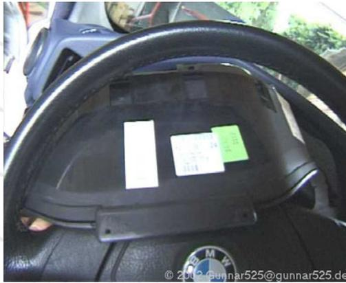
Abbildung 52: Kombi ohne Lenkradausbau entfernen
