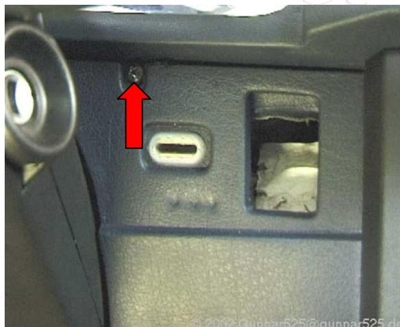
**Abbildung 37: Schrauben der Verkleidung rechts neben der Lenksäule**
