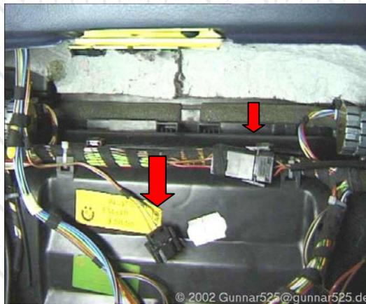
**Abbildung 59: Steckverbindung elektrische Lüftdüse & Radiokontakt**
