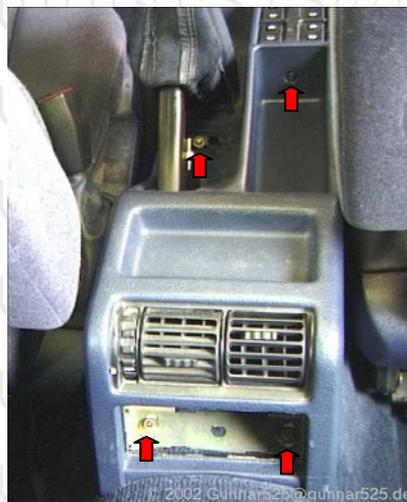
**Abbildung 7: Schrauben der hinteren Mittelkonsole**
