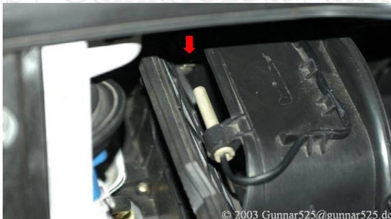
**Abbildung 67: Temperaturfühler und Halteklammer**
