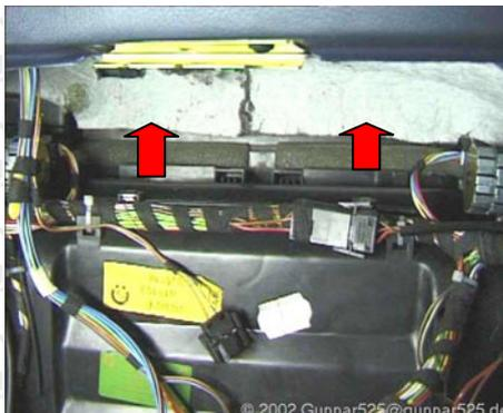
**Abbildung 63: Aufliegen der Luftführungen**
