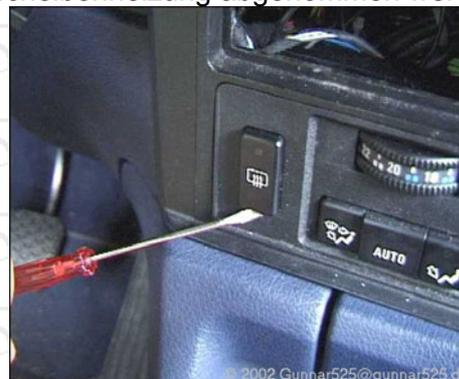
**Abbildung 18: Heckscheibenschalter Klimaautomatik**
