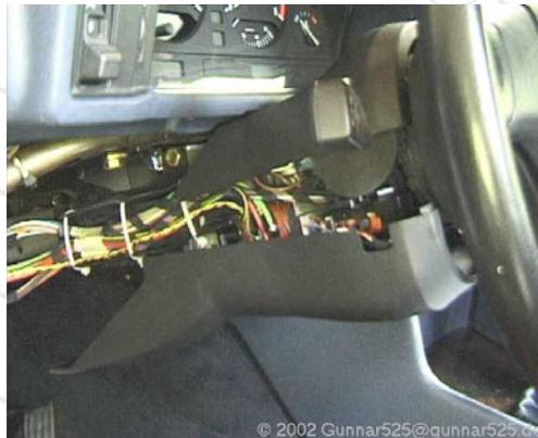
Abbildung 47: Abnehmen der Lenksäulenverkleidung
