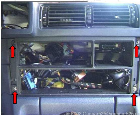
**Abbildung 21: Halterung BC / Uhr, Radio und Heizungsbedienteil**
