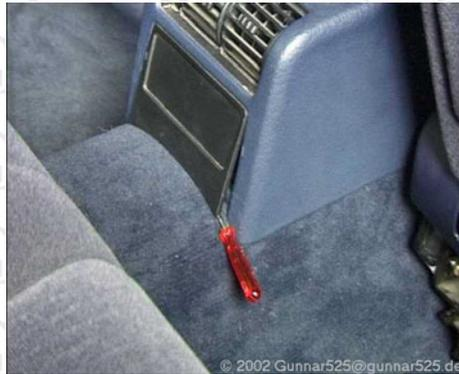
**Abbildung 6: Abdeckung Mittelkonsole im Fond**
