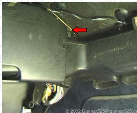
**Abbildung 42: Schraube Luftführung beim Handschuhfach**
