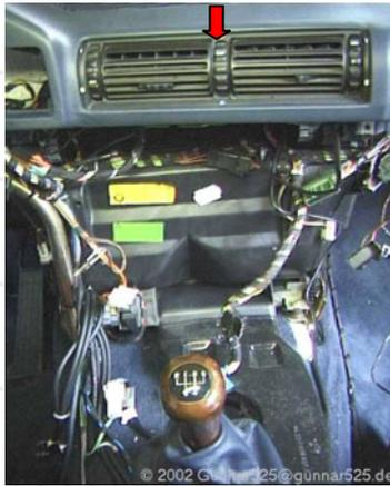
**Abbildung 58: Kabel aus dem Armaturenbrett zur Mittelkonsole**
