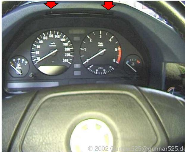
**Abbildung 50: Schrauben des Kombiinstrumentes**
