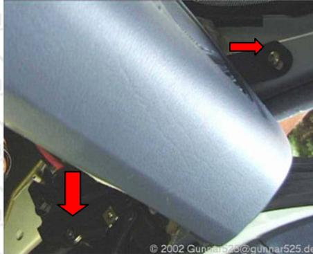
**Abbildung 61: Schrauben des Armaturenbretts**
