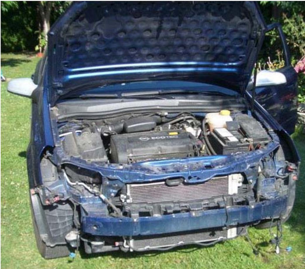
**Abbildung 2: Demontierte/r Frontschürze, Scheinwerfer und Sicherungskasten**
