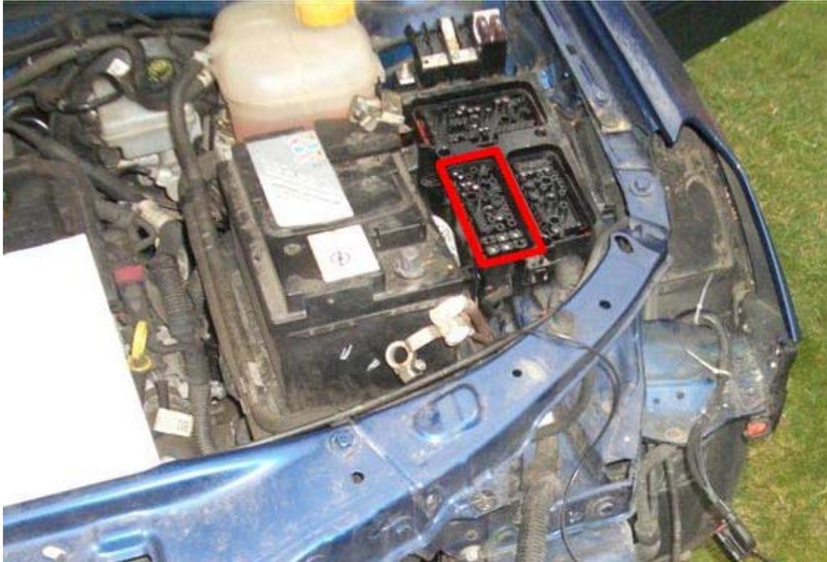
**Abbildung 5: Stecker XE1 im Sicherungskasten (rot markiert)**
