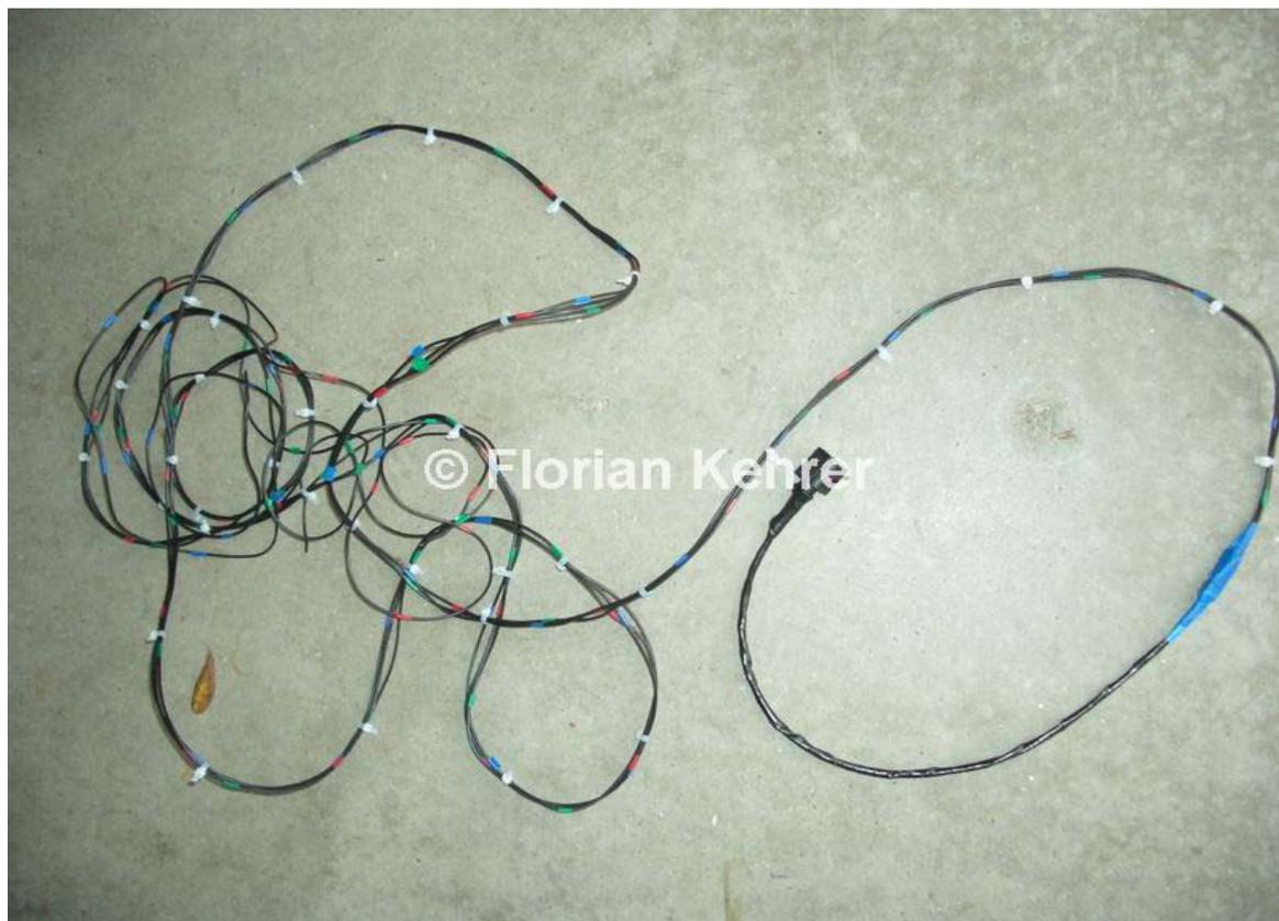
Abbildung 16: Vorkonfektionierter Frontkabelbaum zum optionalen Kompletttausch
