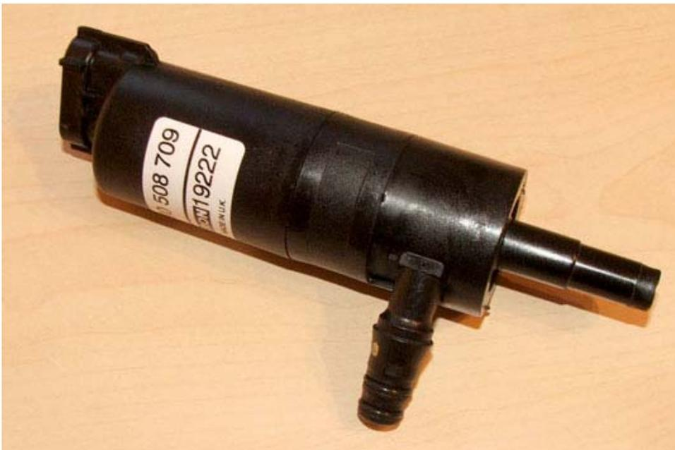
**Abbildung 12: Die SRA-Hochdruckpumpe**
