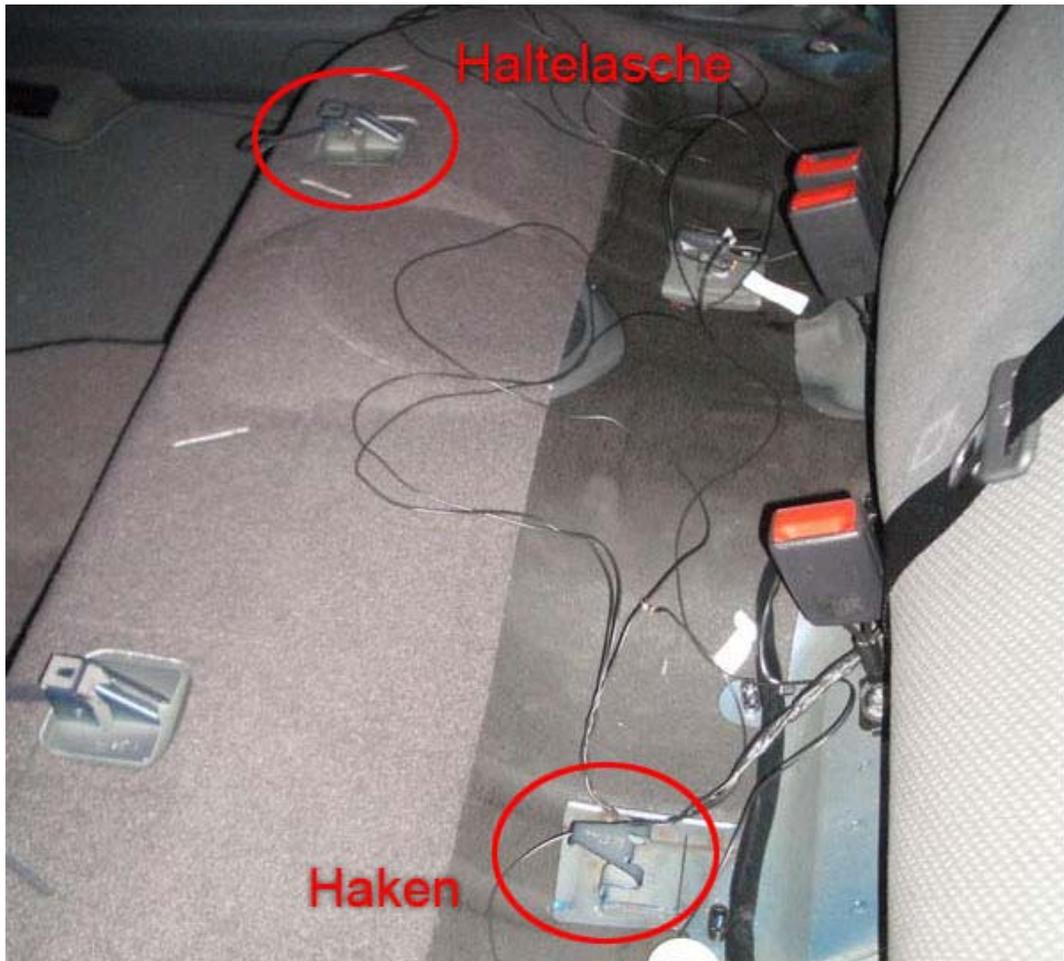
Abbildung 7: Befestigungen der Rücksitzbank (demontiert)
