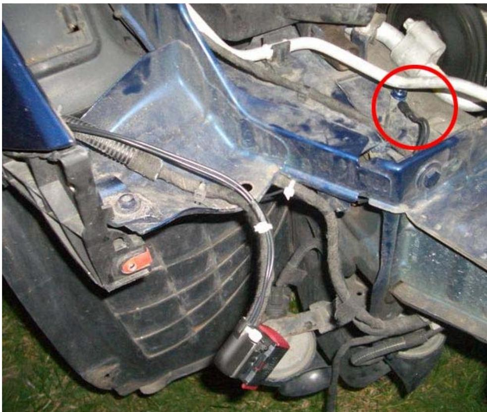
Abbildung 4: Massepunkt unter dem Luftfilterkasten
