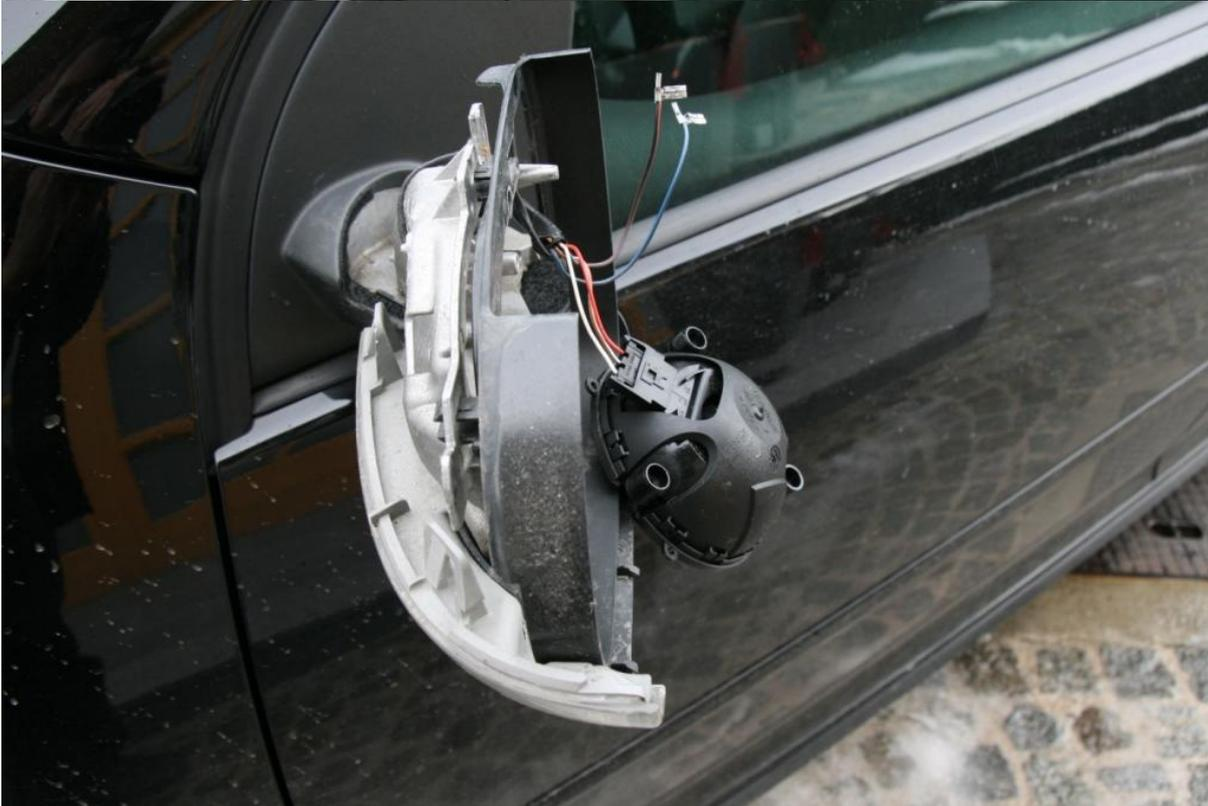
Jetzt den Spiegelunterteil entferne. Hierzu die beiden Schrauben entfernen und nach unten wegziehen. Jetzt auch die Schrauben des Spiegelblinkers entfernen!
