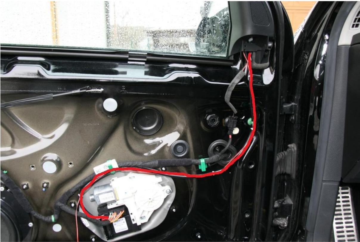
Den Stecker am Steuergerät entfernen und das Gehäuse des Steckers entfernen.
