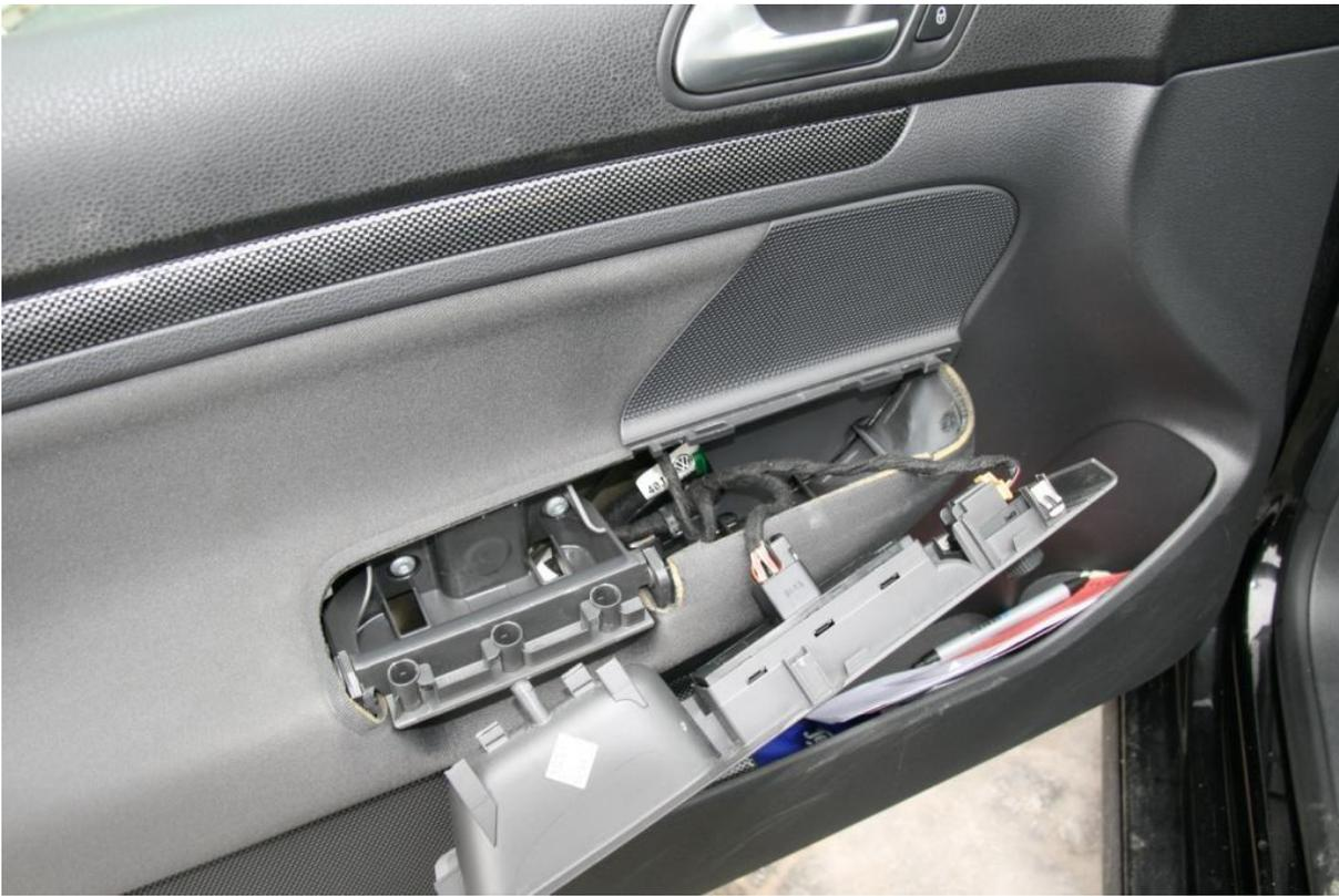
1. Jetzt die beiden Schrauben hinter der Verkleidung entfernen.
