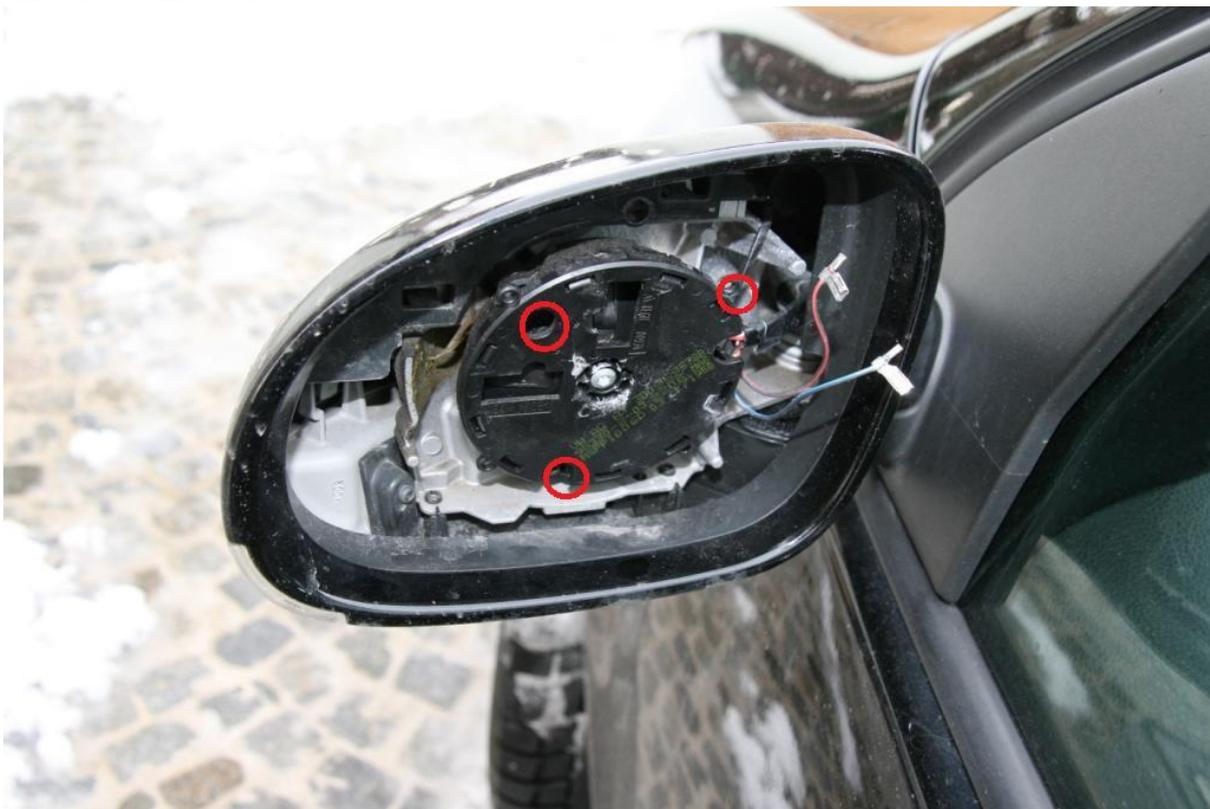
Ist der Motor demontiert, kann man die Spiegelkappe entfernen. Dazu die zwei Aufnahmen am Spiegelblinker wegdrücken und das Gehäuse nach oben entfernen.
