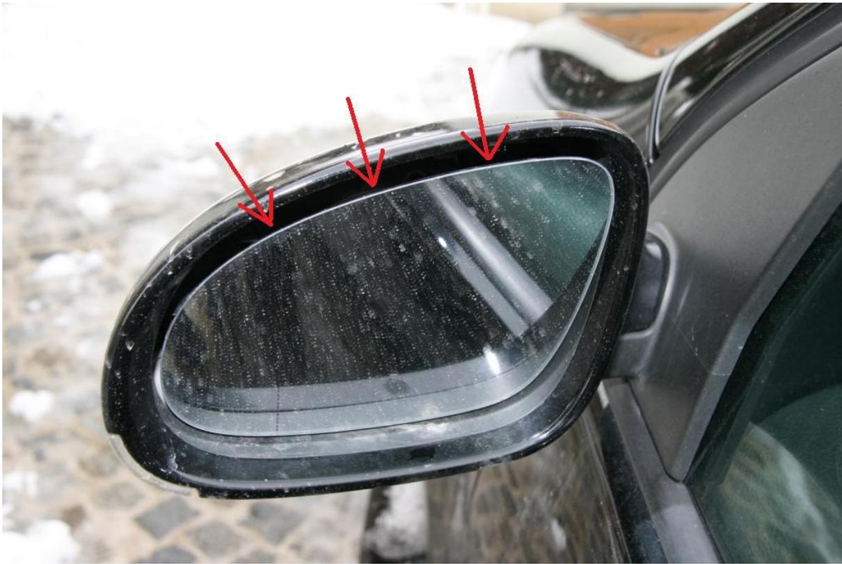
Die Leitungen der Spiegelheizung abstecken, und den Spiegelmotor demontieren.
