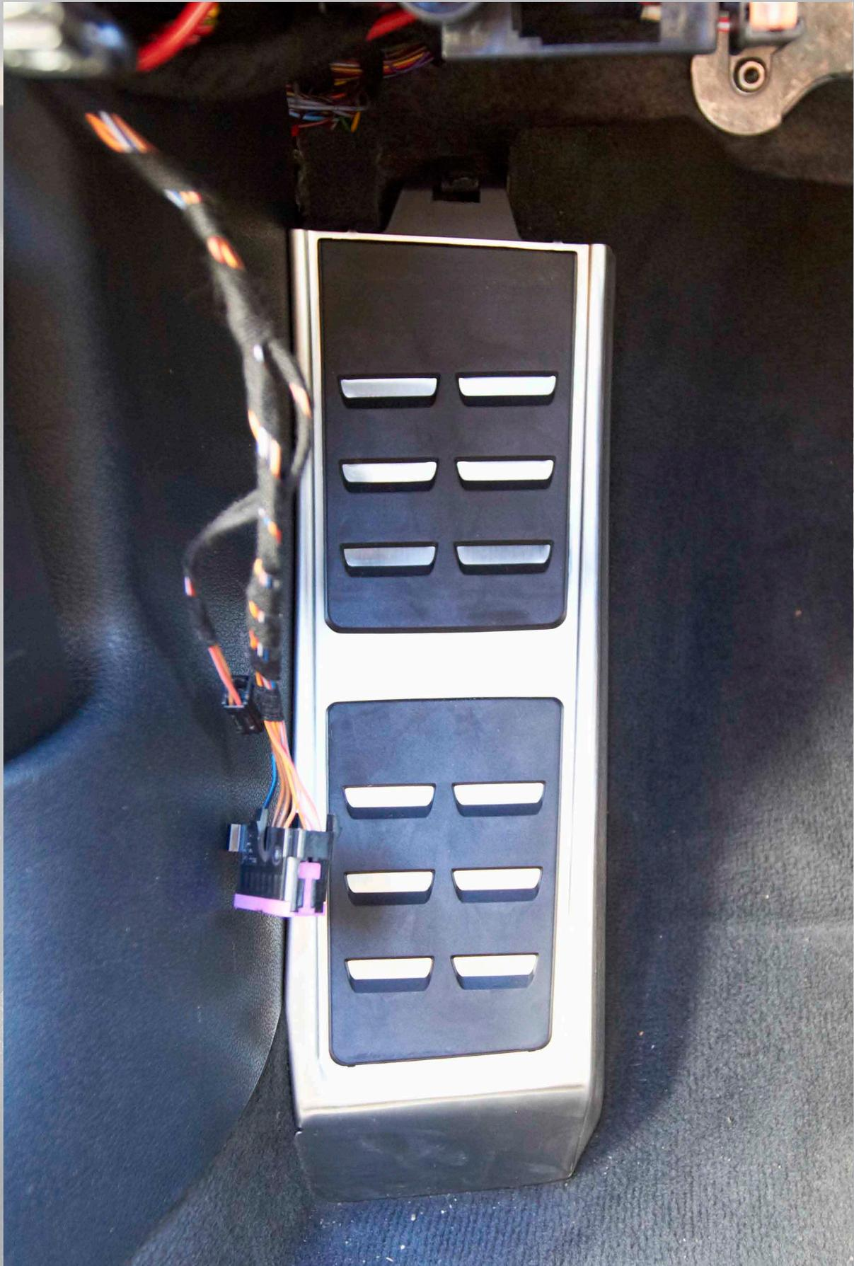
Nun die Verkleidung wieder montieren. Dazu alle Stecker wieder einstecken, dabei auf die Einrastung der Sicherungen der Stecker achten. Die Verkleidung zuerst nur grob fixieren. Erst wenn die Spaltmaße ausgerichtet sind, die Schrauben fest anziehen. Die kleine Blende oben rechts wieder einclipsen und mit Cockpitspray eventuelle Einbauspuren reinigen.
