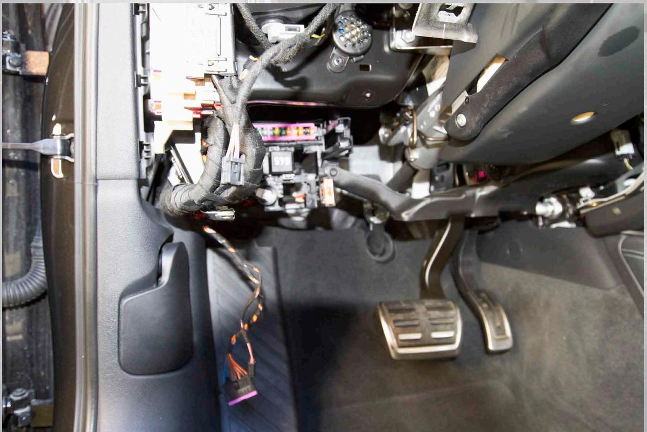
Jetzt die alte Fuß-Stütze von der Pedalseite her anheben und ausclipsen. Die Nut welche auf der linken Seite der Stütze ist, greift in die Seitenverkleidung ein. Das lässt sich mit sanftem Druck nach oben rausziehen. Die Seitenverkleidung ist ausreichend flexibel ohne zu Bruch zu gehen. Den Teppich und den aufgeklebten Schaumstoffblock nach rechts wegziehen.
