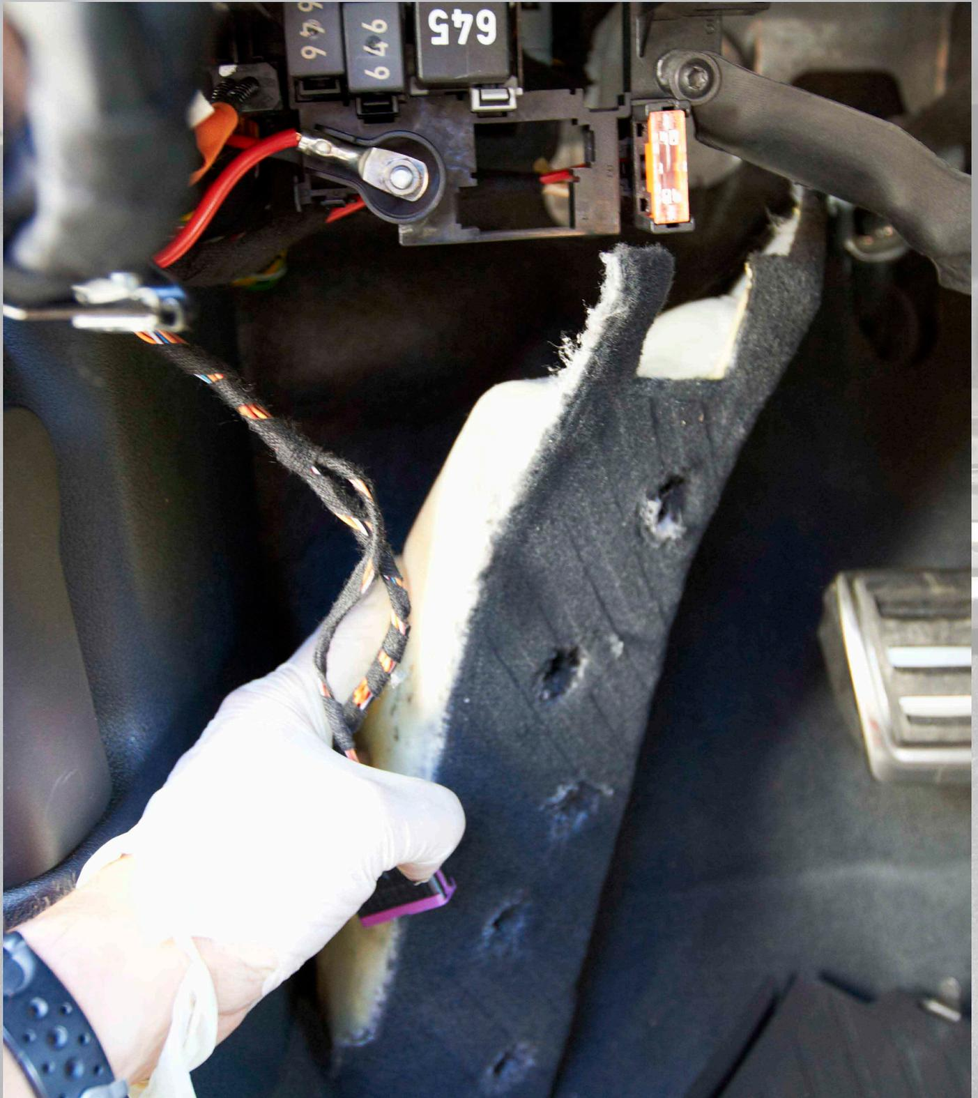
Jetzt die neue Fußstütze zuerst mit der Nut (zur A-Säule) einsetzen. Dazu die Seitenverkleidung von der A-Säule etwas wegziehen, die Nut hinter der Verkleidung platzieren und die Stütze gemeinsam mit der Verkleidung und dem Schaumstoffblock wieder in die richtige Position zurückdrücken. Jetzt kann die Position der Stütze noch etwas nach oben/unten korrigiert werden und erst dann drückt ihr die Haltestifte der Stütze in den Schaumstoffblock.
