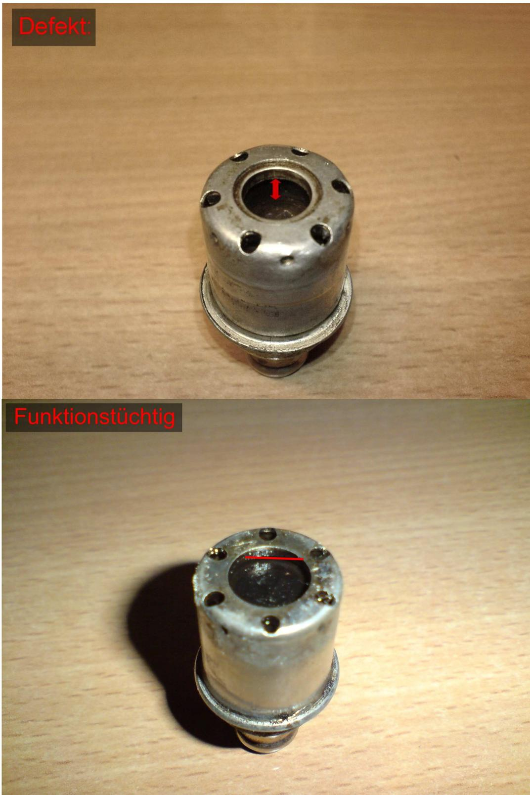
(Bei dem defekten Ventil ist die Feder gebrochen, sodass sich das Ventil im Gehäuse lose bewegen konnte. Daran zu erkennen, dass das Ventil 5mm offen war, wenn man es Überkopf kippte)
