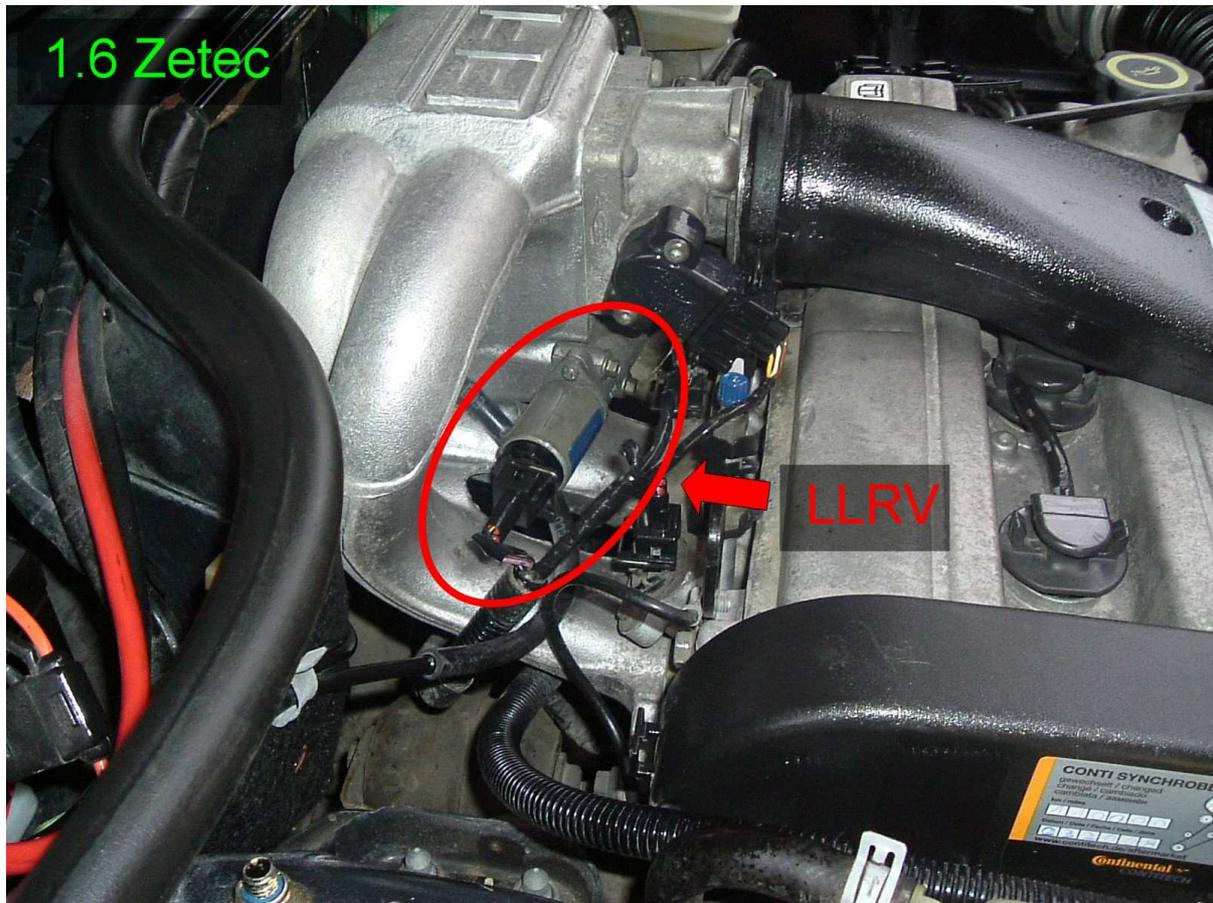
Zunächst sollte man das Ventil einer Reinigung unterziehen und mit Kriechöl wieder gangbar machen. Dabei muss darauf geachtet werden, dass keine Flüssigkeit in das Gehäuse des Stellmotors eindringt. Unter Umständen muss das Leerlaufregelventil ersetzt werden, wenn der Fehler bleibt.
