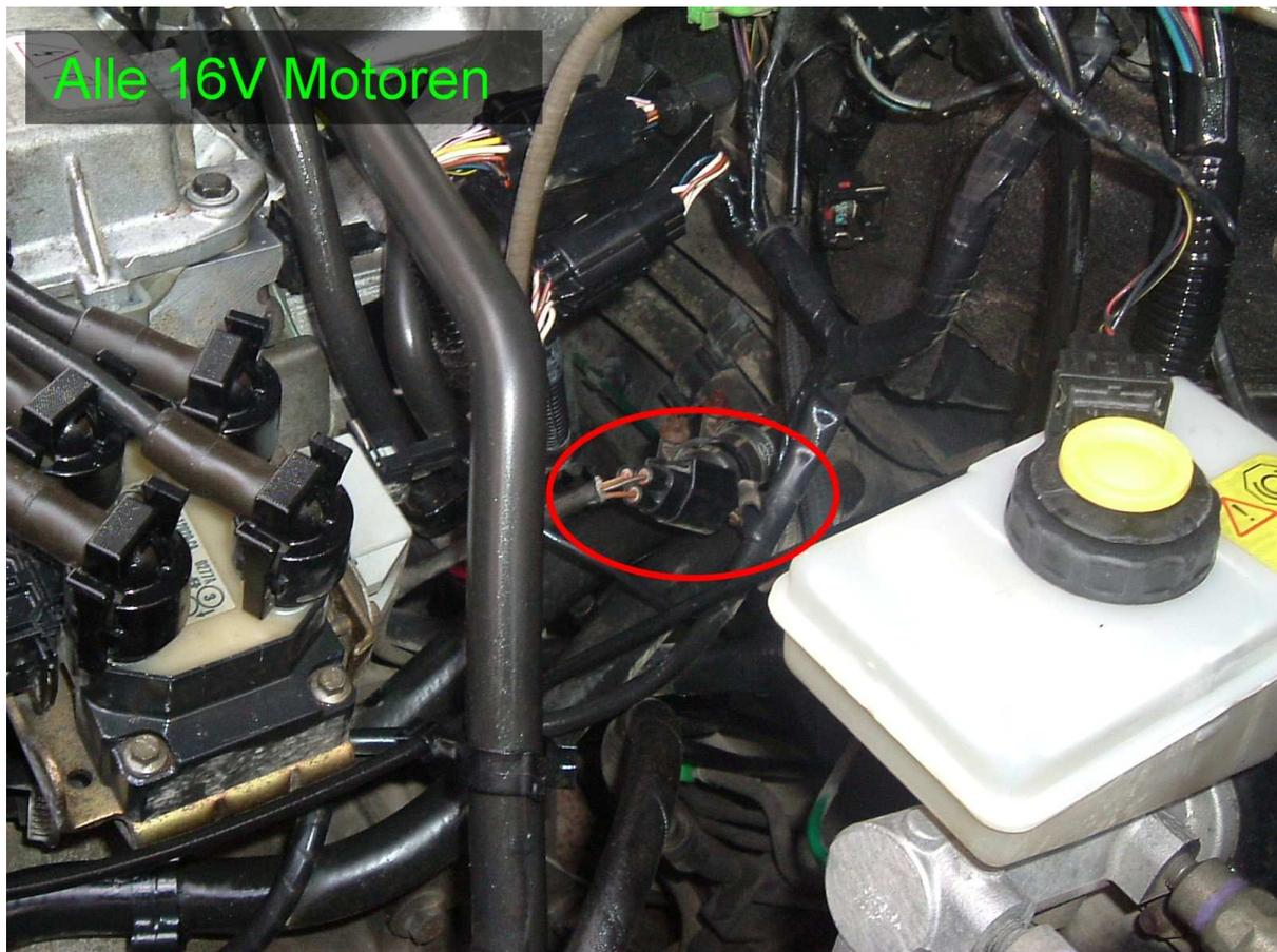
Hierzu bei stehendem Motor sämtliche Steckerkontakte von Korrosion befreien und Kontakte mit Kontaktfett/-spray behandeln.
