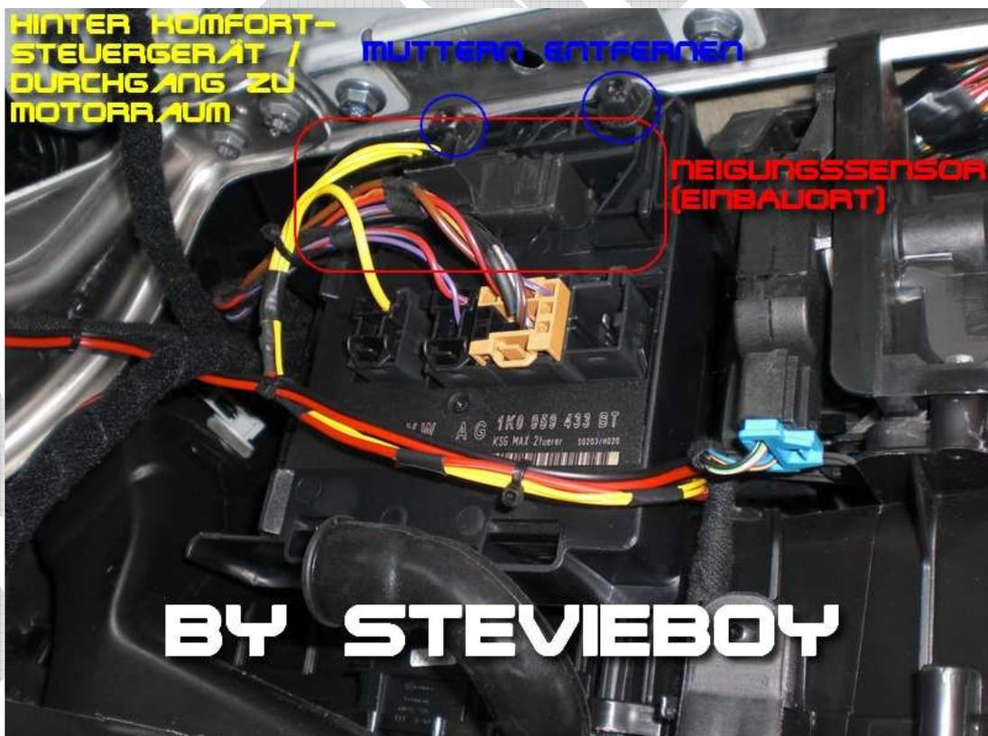
**EINBAU DER VERKLEIDUNGS-TEILE IN UMGEDREHTER REIHENFOLGE !!**
