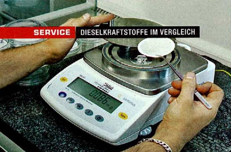
Teil der Abgasanalyse: Ruß- und Partikel-Ermittlung durch Wiegen eines Prüfplättchens nach dem abgeschlossenen Abgastest
