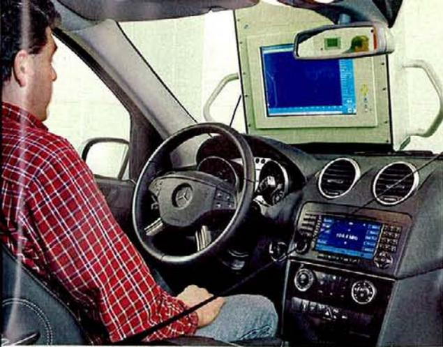
Abgasmessung: Auf dem Rollenprüfstand wird ein vorgeschriebener Zyklus exakt abgefahren
