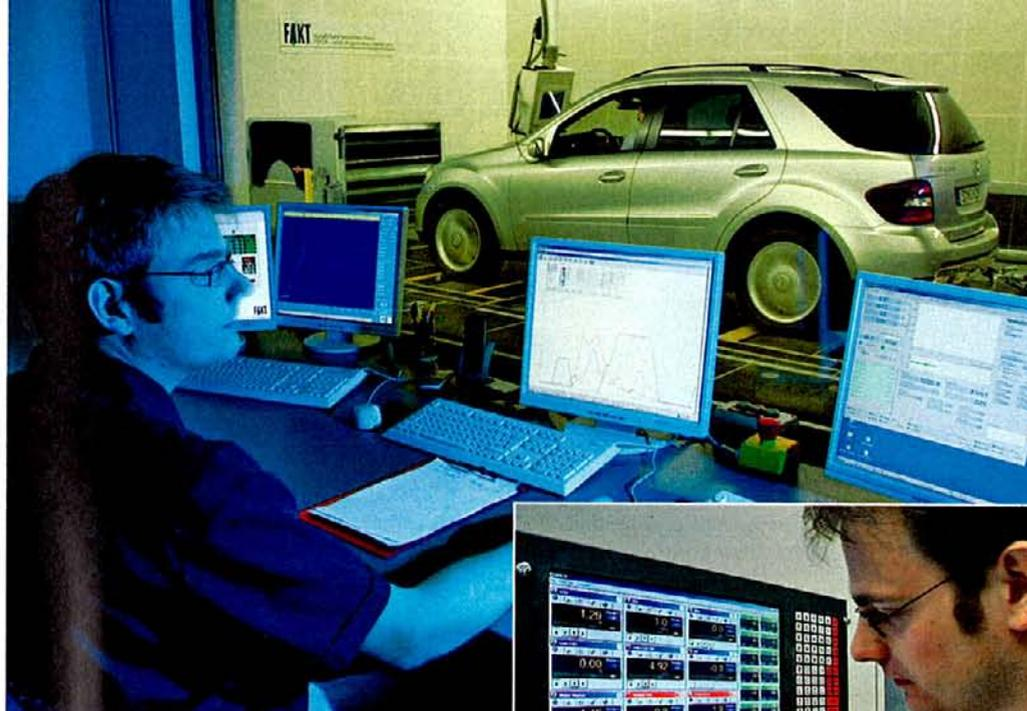
Immer unter gleichen Bedingungen: Abgas- und Leistungsmessung mit den zu vergleichenden Kraftstoffsorten auf dem Rollenprüfstand des Kraftfahrtechnischen Prüf- und Ingenieurzentrums FAKT in Heimertingen (oben). Die automatisierte Abgas-Messtechnik (rechts) zeigt die Analyse-Ergebnisse auf einem großen Display an
