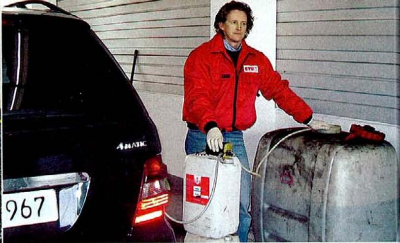
Abpumpen des Test-Diesels nach jeder Prüfrunde durch die GTÜ (Gesellschaft für Technische Überwachung). Anschließend erfolgt eine Spülung des Kraftstoffsystems
