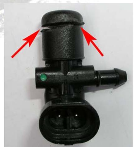
Mit der Trennscheibe so tief wie möglich schneiden.
