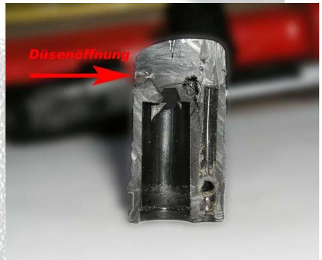
Als erstes wird der Kopf der Düse „abgedremelt“.
