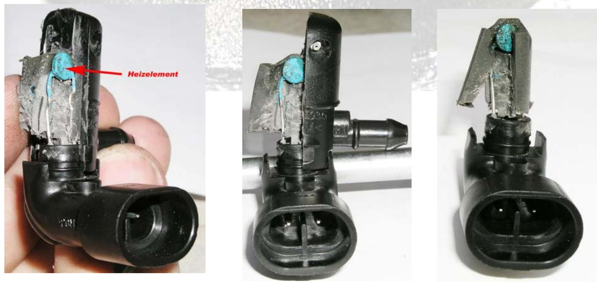
Auf den Bildern sieht man sehr gut, dass das Heizelement in eine Art Gummiumhüllung eingegossen ist.
