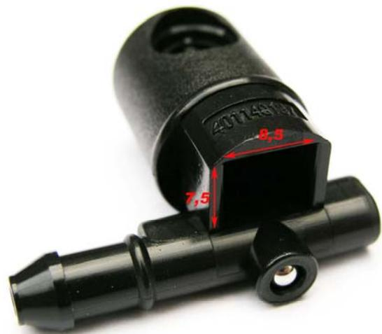
Anschließend ein Größenvergleich der „alten“ Vectra C Spritzdüsen mit den „neuen“ Insignia Spritzdüsen:
