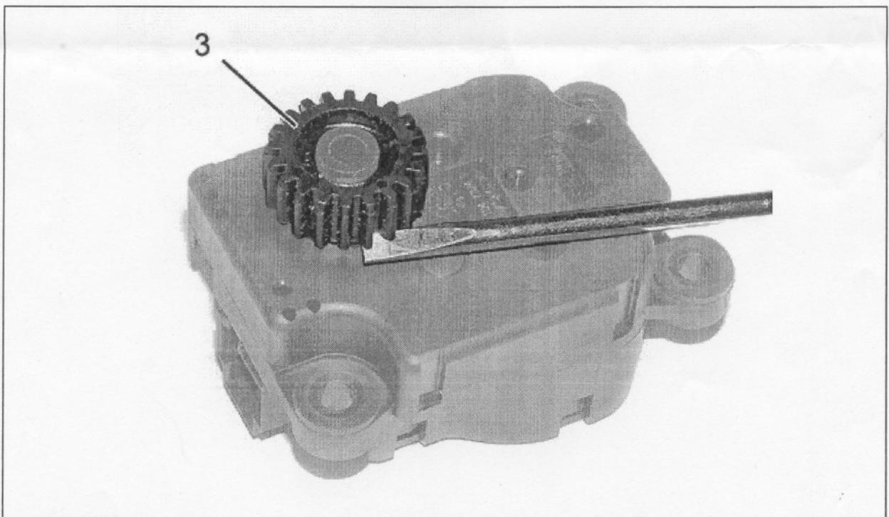
Das Zahnrad (3) des Stellmotors der Luftmischklappe (2) ausbauen ; Mit Hilfe eines Schraubendrehers .
