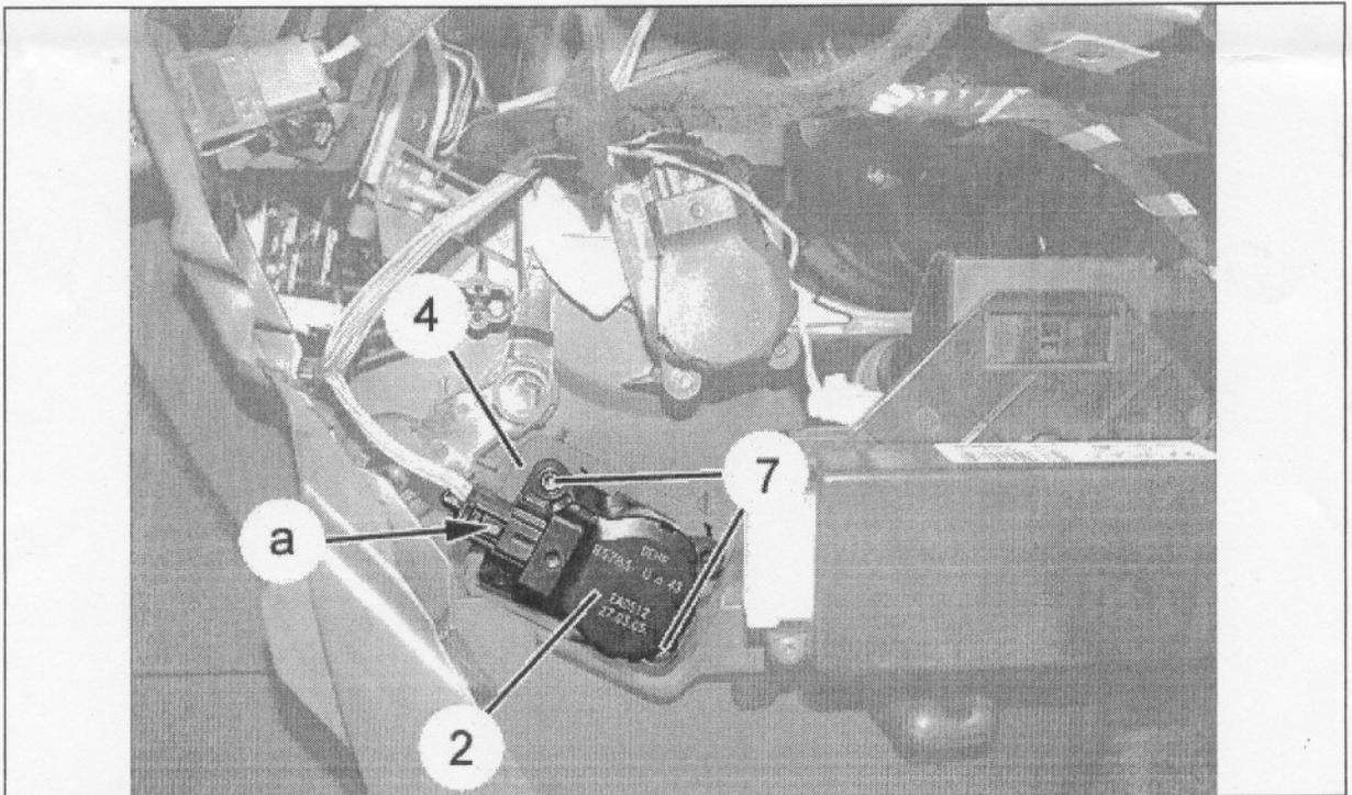
Die Einheit komplette Adapterplatine mit Stellmotor der Mischklappe (2), (4) am gesteckten Adapterzahnrad (6) anordnen.
