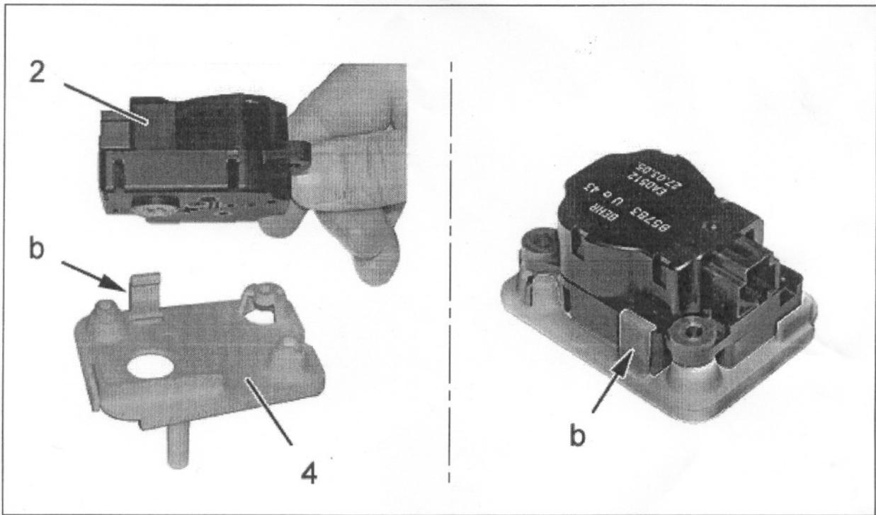
Stellmotor der Luftmischklappe (2) an der Adapterplatine (4) anbringen.
