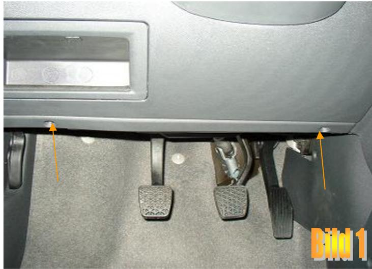
Dann legen wir das Kabel in den Innenraum. Innen wird die Abdeckung über den Pedalen abmontiert. Einfach die zwei Schrauben lösen, jetzt kann man die Abdeckung abziehen. Wenn man sie nicht runter bekommt ist weiter links noch eine Schraube die man lösen kann.
