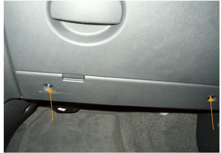
Die mit Pfeilen gekennzeichnet Schrauben müssen entfernt werden, zum Ausbau des Handschuhfaches. Im Handschuhfach sind auch noch zwei Schrauben.
