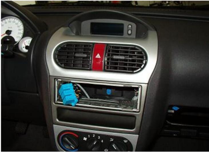
Hier wurde bereits der Din Adapterrahmen eingebaut.
