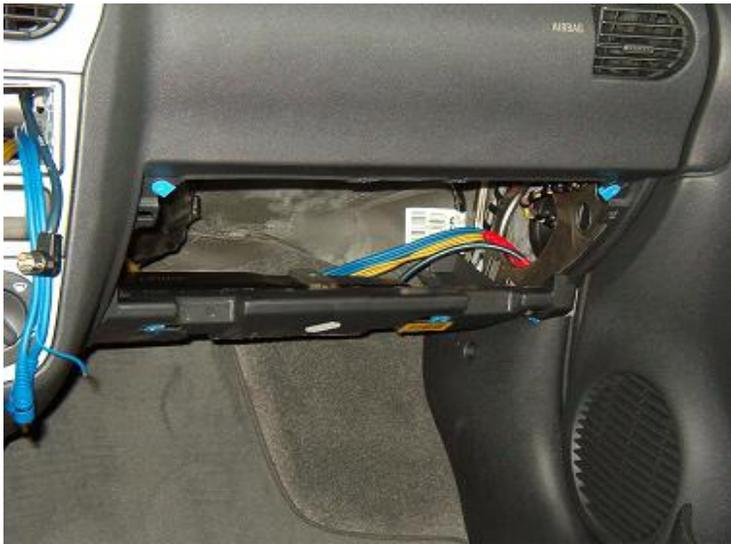
Kabel werden auch hier wie in der Fahrerseite nach hinten verlegt. Durch den Ausbau des Handschuhfaches hat man vollen Zugriff auf die Freiräume im Armaturenbrett und es lässt sich später auch das Radio leichter einbauen, da man von hier die Kabel nach hinten ziehen kann. Es sollte aber aufgepasst werden, dass die Kabel so lang sind, dass das Handschuhfach noch eingebaut werden kann. 5 m Chinch sind hierfür lang genug.
