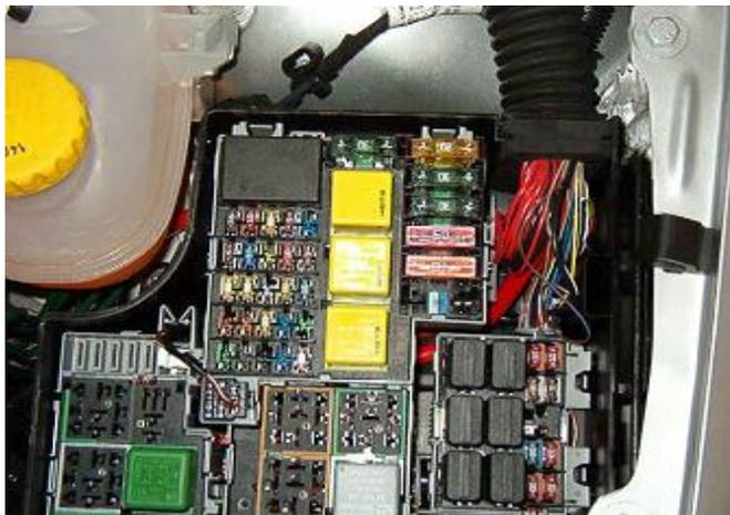
Wenn es fertig ist müsste es so aussehen. Der Sicherungseinsatz wurde wieder eingebaut und das Loch sauber ausgespritzt.
