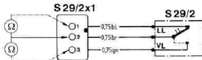
S29/2 Drosselklappenschalter Vollast-/Leerlauf-erkennung
