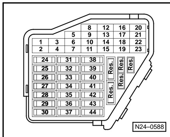
Sicherungen ab S 24 werden im Stromlaufplan mit einer zusätzlichen 2 gekennzeichnet:
