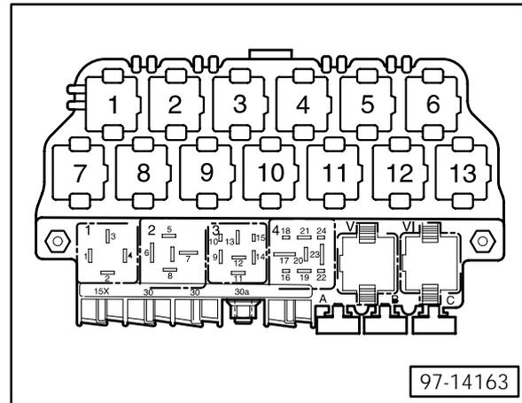
**Sicherungsbelegung auf der Relaisplatte**
