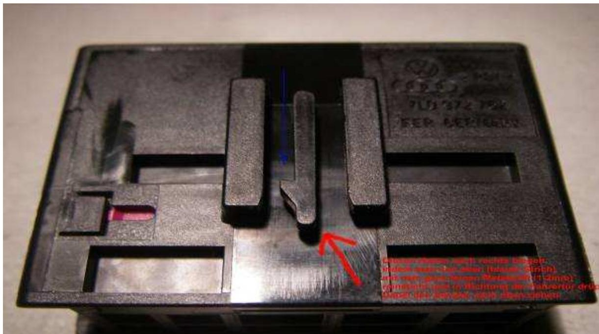
Text im Bild: Abbildung zeigt die Buchse der SH zur Fahrzeugseite hin; mit dem Haken ist sie im Halterahmen unter der vorderen Abdeckung unter den Vordersitzen arretiert, Zum Lösen einen dünnen Stift (z.B. sehr kleinen Schraubendreher (1-2mm)) von oben (blauer Strich) einführen und diesen dann an seinem oberen Ende zur Fahrertür hindrücken, etwas wackeln und dabei das ganze Teil nach oben ziehen. **NIE etwas mit Gewalt probieren!** Auf dem nächsten Bild das ganze noch mal im eingebauten Zustand.
