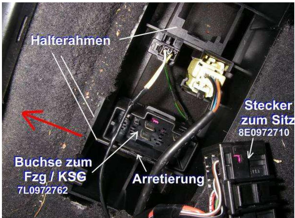
Da wo „Arretierung“ steht genau an der Pfeilspitze den Metallstift (Minischraubendreher) einführen und an seinem oberen Ende etwas in Richtung des roten Pfeils drücken, dabei die Buchse nach oben (in Richtung Fahrzeugdach) ziehen.
