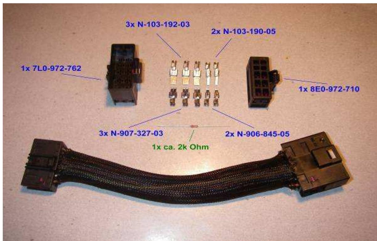
Teilleiste mit TN's; unten der erste Adapter (meiner) mit Gewebe-Flexschlauch.
