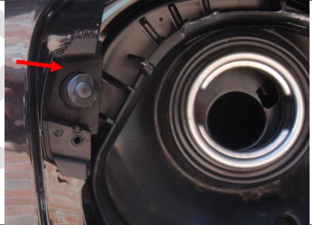
Stellelement zum Einfüllstutzen hin abziehen
