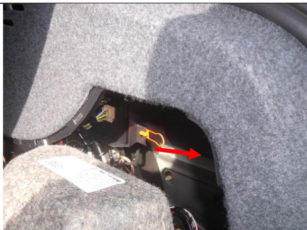
Elektrische Steckverbindung trennen und Stellelement inkl. Zug der Notfallentriegelung entfernen
