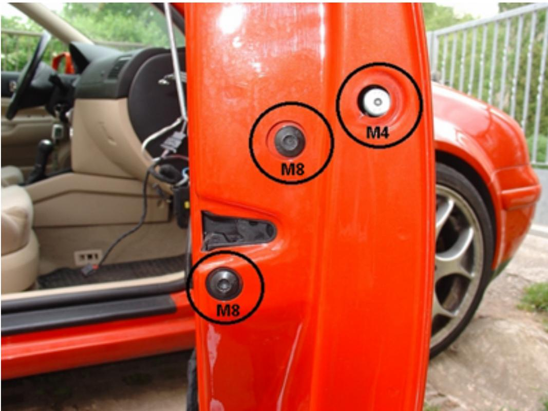
Zunächst muss bei gezogenem äußeren Türgriff der Schließzylinder gelöst werden. Dafür benötigt man einen Spezialbit der Größe M4. Die Schraube dreht man soweit raus bis ein leichter Widerstand zu merken ist, aber nicht weiter!!! Den Schließzylinder herausziehen und ablegen. Danach werden die beiden großen schwarzen Schrauben mit dem Spezialbit M8 herausgedreht.
