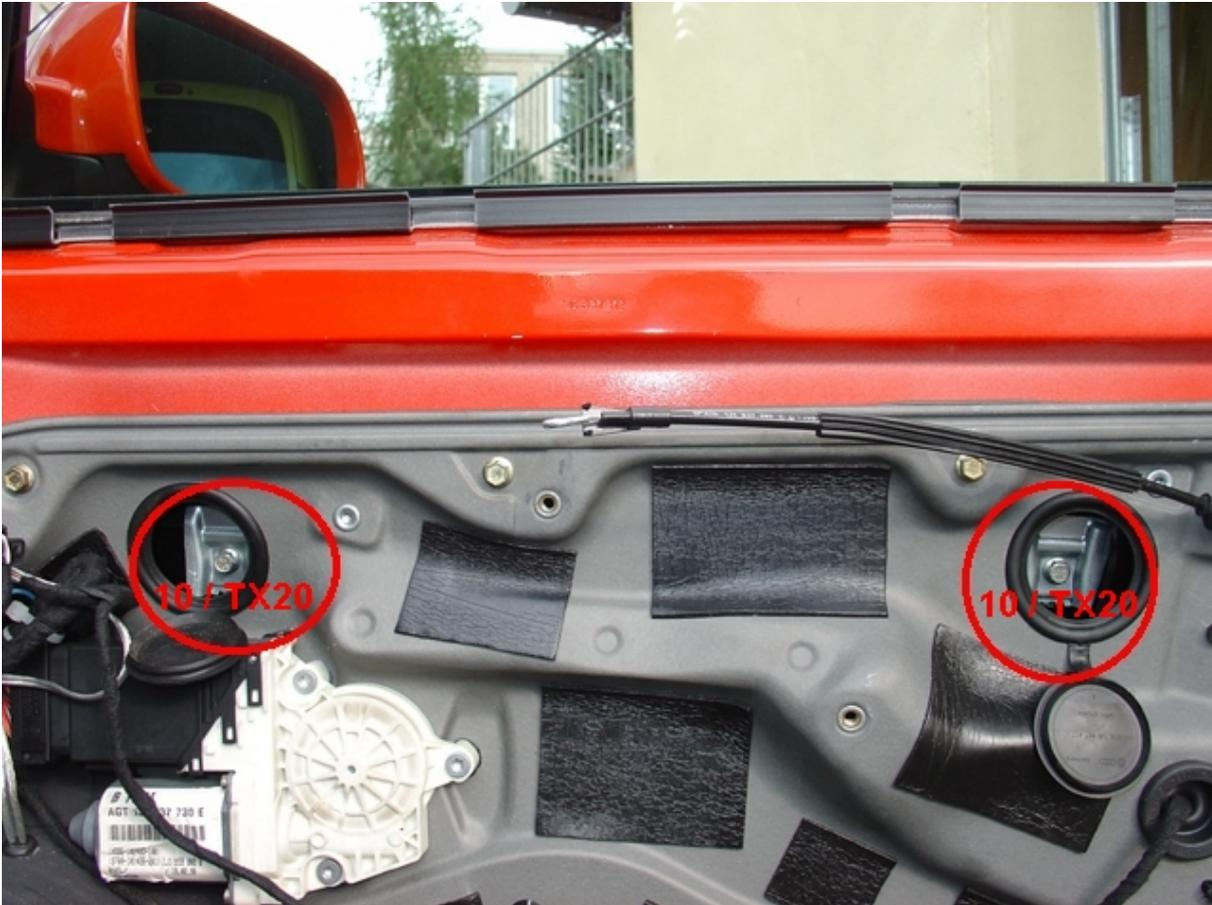
Die Scheibe ist mit einer 10er Stecknuss oder einer TX25 Stecknuss zu lösen. Danach kann man sie einfach nach oben aus dem Fensterschacht ziehen. Vorsicht mit dem Lack und dem Dichtungsgummi, das vorbeischrannen hinterlässt Kratzer!
