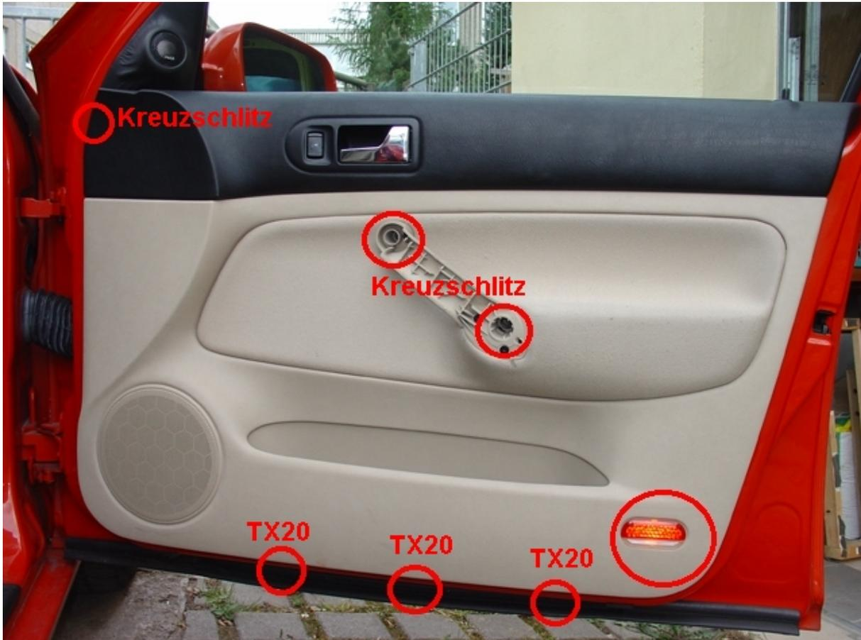
Die Schalterverkleidung der Fahrertür ist geclipst und geht recht einfach ab (Stecker abziehen). Die Verkleidung der Beifahrertür ist etwas schwerer abzubekommen, weil man leicht Kanten in die gummierte Oberfläche drückt. Es ist also unbedingt notwendig einen sauberen Lappen unterzulegen und von unten zu arbeiten. Dann sieht man etwaige Kerben nicht sofort. Nun wird noch die Lampe entfernt, Stecker ab, fertig.
