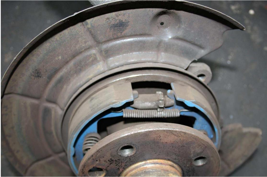
Dann von hinten den ABS-Sensor abziehen, auf diesem Bild gut zu sehen (das weiß-blaue Ding) und die vier Muttern der Radnabe lösen (hier schon die neuen zu sehen):
