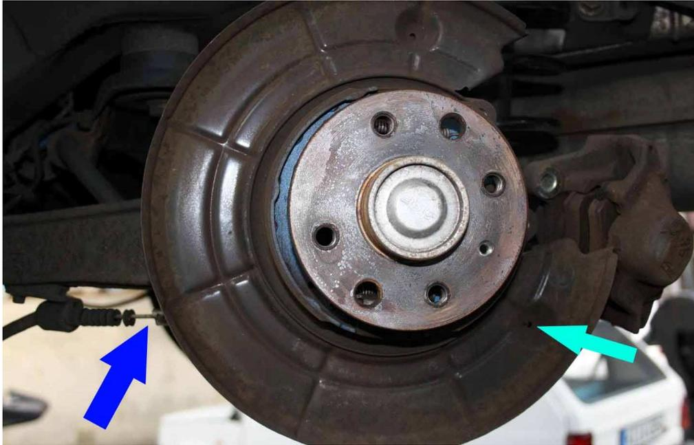
Jetzt kann die Radnabe von hinten raus geklopft werden, ging bei mir richtig schwer, jede Menge Öl und relativ fest mit dem Hammer drauf gehauen bis die sich gelöst hat. Man sieht hier auch nur noch zwei der Bolzen, die anderen haben sich beim Rausschrauben mit gelöst. Auf dem Bild sind der Haken des Handbremsseils (roter Pfeil) und das Loch zur Befestigung der Feder (wieder türkiser Pfeil) zu sehen:
