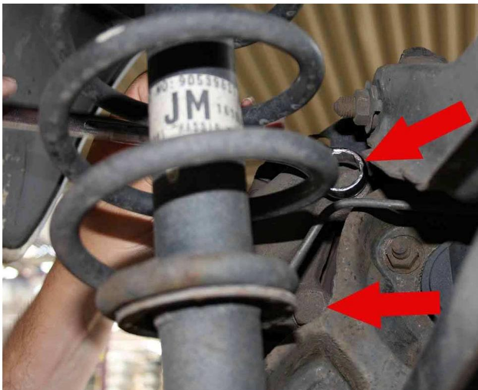
Als nächstes die eine Kreuzschlitz-Schraube der Bremsscheibe lösen (siehe Bild 1 gelber Pfeil) und die runter ziehen. Eventuell etwas wackeln, geht meist schwer.
