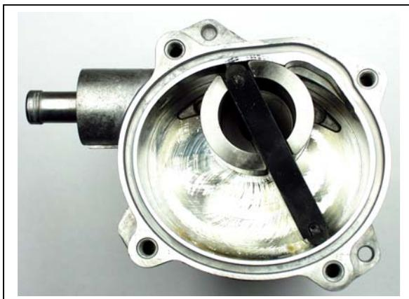
Das Bild links zeigt eine Vakuumpumpe mit abgenommenem Deckel.
