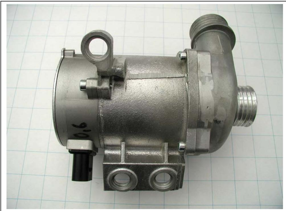
Der Elektromotor der Pumpe wird vom Kühlmittel durchströmt, dadurch gekühlt und geschmiert. Ein Trockenlauf würde die Pumpe sehr schnell zerstören. Daher ist bei der Befüllung des Kühlsystems ein Entlüftungsvorgang erforderlich, damit keine Luft im System zurückbleibt.
