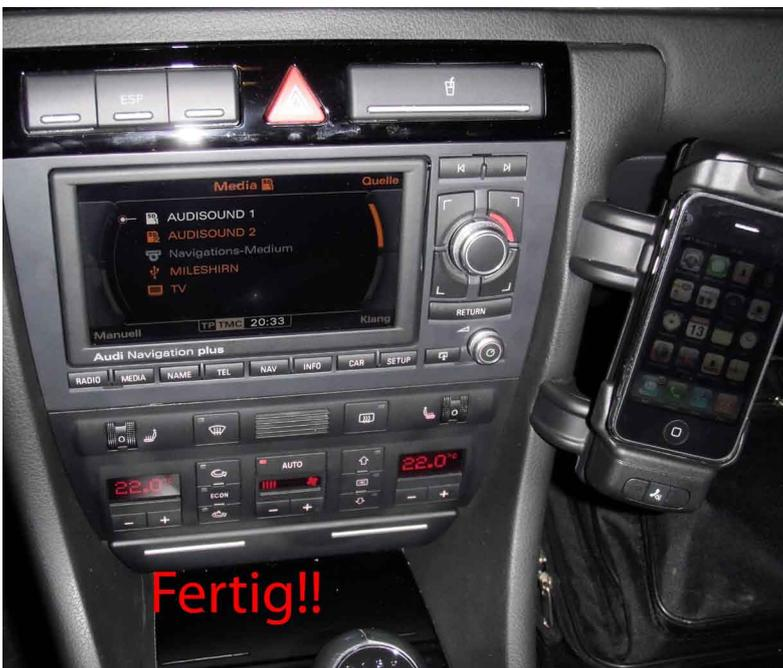
Da sieht man dann den eingebauten Zustand. Dauer des Umbau beim ersten mal ca. 1,5 Stunden.
