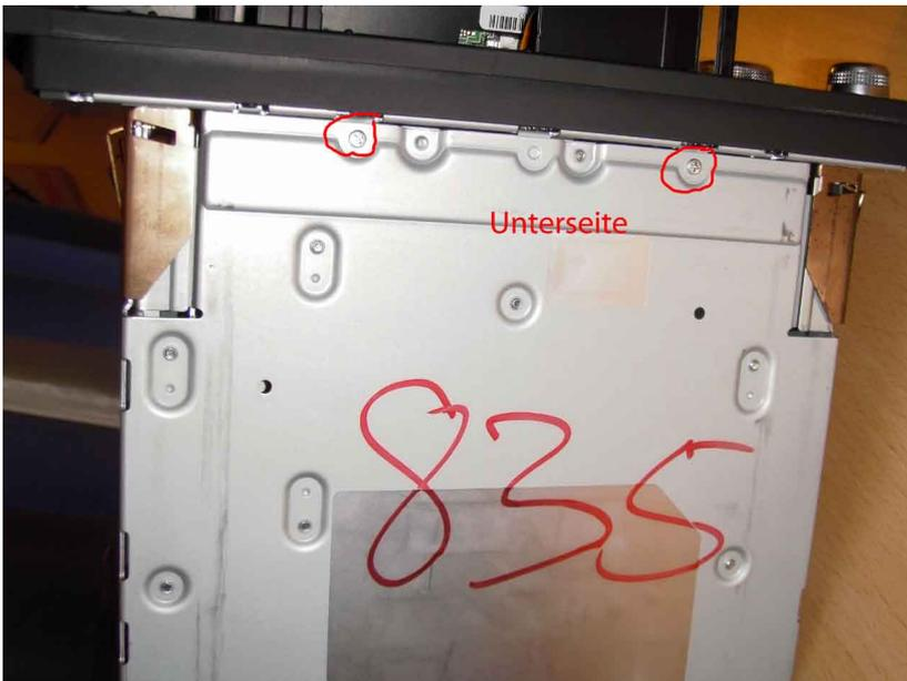
2 Schrauben befinden sich an der Unterseite
