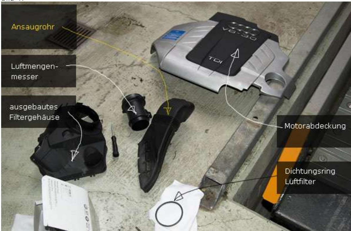
Beim Zusammenbau habe ich erst den Filter in den Filterkasten geschraubt und dann den Filterkasten eingesetzt.
