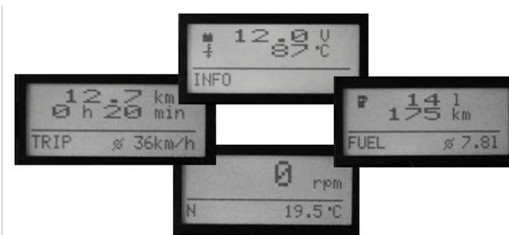
Abbildung 2: Standard-Display-Anzeigen
