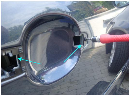
Diese Schraube ist wie eben gesagt mit dem Torx Schraubenzieher einfach zu lösen. Das innen liegende Türgriffhalteblech (türkis) ist noch innen befestigt und wird somit nicht herunterfallen.
