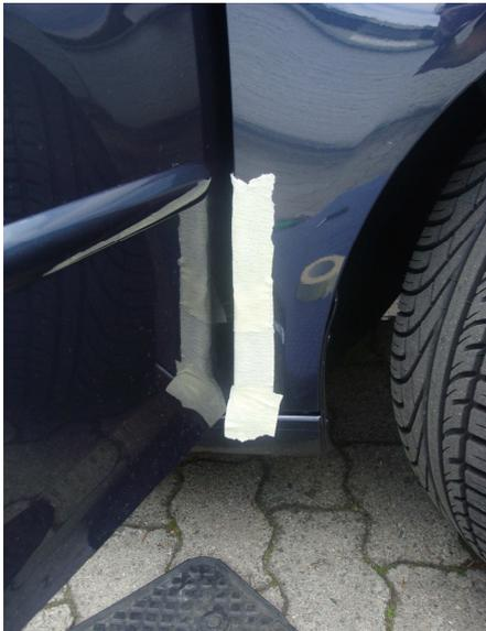
Um Schäden an der Türe zu vermeiden bitte ich euch mit, wenn möglich, weichem Klebeband die Kotflügelkanten abzukleben, um Kratzer und Dellen zu vermeiden. Vorsicht kann nicht schaden.
