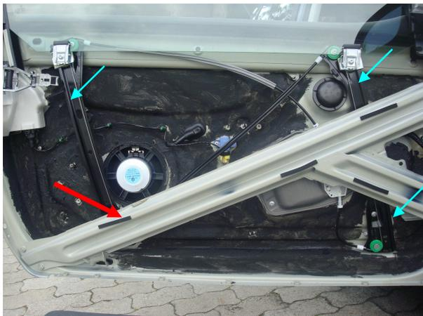
Hier kann nun nach Herzenslust gedämmt werden; egal ob Brax ExVibration (wie hier) oder Bitumenmatten oder Alubutül oder oder... Wichtig ist nur, dass der Fensterheberlauf (türkis) unbeeinflusst bleibt, von sämtlichen Dämmaktionen.
