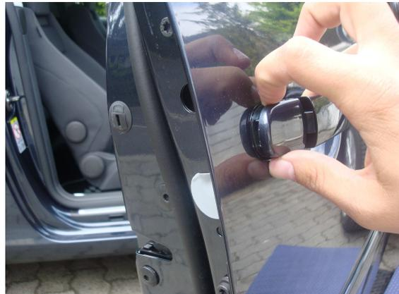
Es bietet sich an, die Schraube mit der linken Hand zu lösen und gleichzeitig wie rechts zu sehen, den Türgriff und das Schloss mit der rechten Hand leicht anzuziehen.
