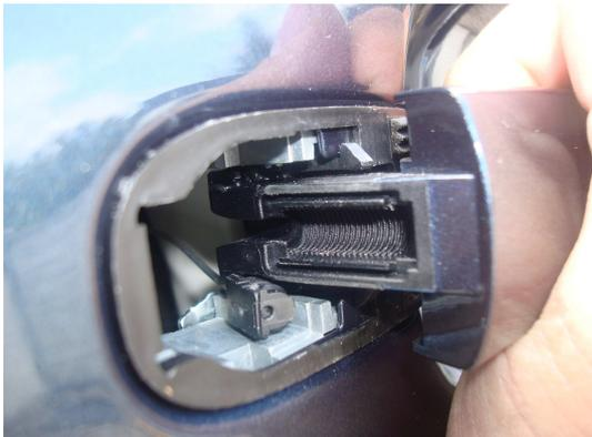
Nun gilt es den Türgriff auszuhängen. Dies erfolgt, indem man den Türgriff leicht anzieht und in Richtung Türaußenkante zieht. Wie hier im Bild nach links. Nun kann der Griff beiseite gelegt werden und eine weitere Torx Schraube wird sichtbar (am Außenblech) → siehe unteres Bild
