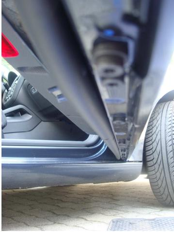
Auf dem linken Bild erkennt man die untenliegenden Schrauben, die das Blech zusätzlich stabilisieren, diese müssen ebenso gelöst werden und zwar allesamt. Dies kann ohne Bedenken erfolgen, lediglich die Schraubenlängen unterscheiden sich (2 Arten)
