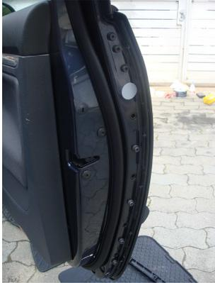
Wie auf dem Foto links klar erkennbar ist, befindet sich im oberen Drittel der Türe ein grauer Klebestreifen, unter dem sich die Demontageschraube für das Schloss befindet. Dieser Streifen kann mit den Fingernägeln gelöst werden. Der Klebestreifen wird später jedoch wieder benötigt → Aufheben
