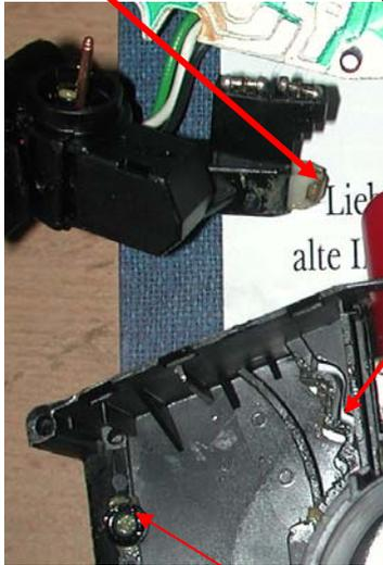
Dann den Hebel in diesen Zapfen führen (man merkt, wenn er einrastet) und dieses weiße Plastikteil wieder einsetzen
