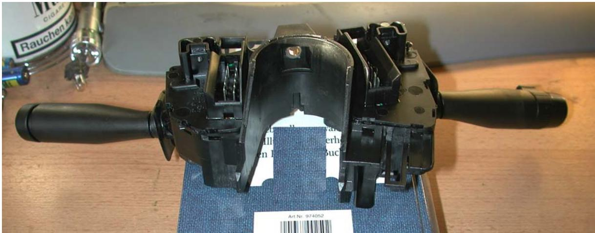
Links und rechts oben werden nun die 2 Schrauben gelöst.
