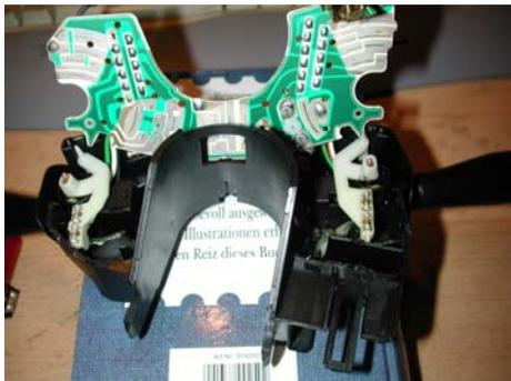
Beim einsetzen der Leiterbahn aufpassen, dass die Aufnahmen des Relais nicht verbogen werden. Auch auf die Kabel achten, dafür ist eine Aussparung vorhanden
