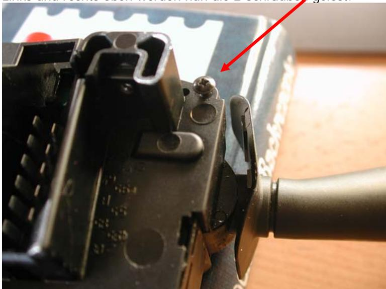
Jetzt mit einem Messer zwischen die Abdeckung und das Gehäuse und die Abdeckung vorsichtig aus den „Clipsen“ hebeln (Dabei ist mir kein einziges abgebrochen).
