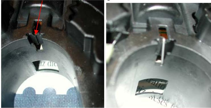
Jetzt heben wir den Bügel von der einen Seite mit dem Finger und setzen von der anderen Seite die Feder ein
