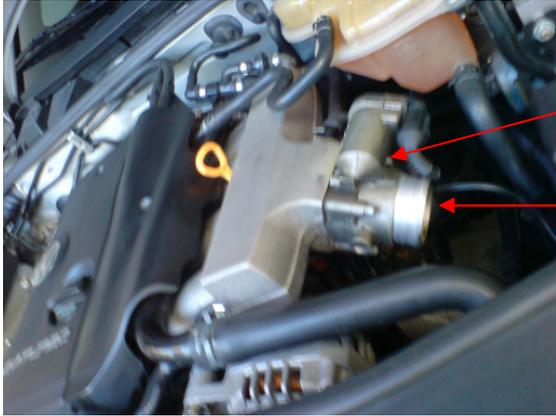
Drosselklappengehäuse mit E-Gas
