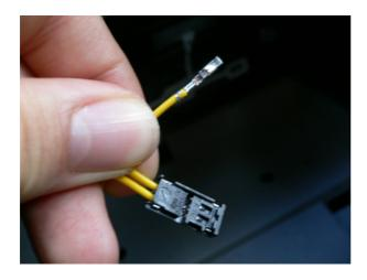
7. Jetzt schließen wir die Lichtleiste an und probieren aus, ob sie funktioniert. Danach wird die Leiste von oben in Richtung Cockpit in den vorhandenen Schlitz geschoben bis er einrastet. Das Bild ist von unten fotografiert.
