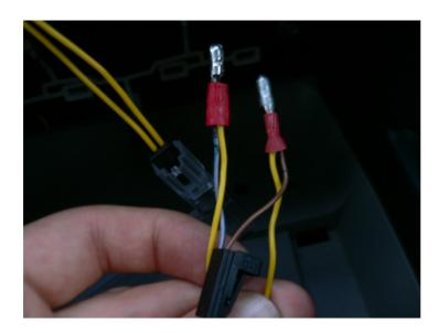
Danach stecken wir das andere Ende der gelben Kabel in den Plastikstecker für die Lichtleiste und machen den Deckel darauf. Die Kabel werden nur eingeschoben und rasten dann ein.
