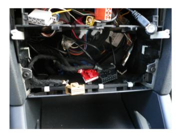
3. Schritt: Entfernen der Blende unterhalb des Bedienteils: Die Blende muss nur an den 3 Nasen entriegelt werden und anschließend nach vorne gezogen werden. Das geht relativ einfach.
