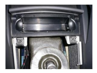
5. Nun geht's ans Eingemachte: Das Verkabeln. Zuerst die zwei Kabel vom Klimabedienteil-Einschub hinten runter, unter der unteren Ablage hindurch zum Kabel von der Aschenbecher-Beleuchtung verlegen. Hier zapfen wir uns Strom ab.
