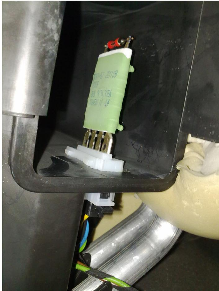
Eingebaut im abgeflanschten Ausgangskanal des Lüfters (Lüfter ist abgebaut, Foto zeigt Luftkanal wo der Lüfter reimpustet); gut zu erreichen, wenn man den Beifahrersitz ganz flach stellt, und sich mit dem Kopf ganz tief in den Fußraum begibt...(ist aber für die Beine sehr bequem. Jetzt weiss ich wofür der Griff am Dachholm ist – zum wiederhochkommen)
