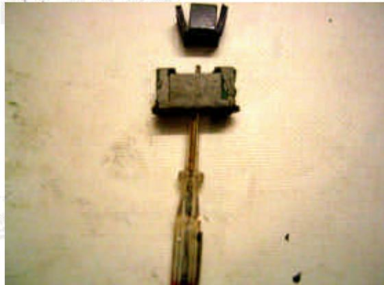
Und noch einmal: Oben Dämpfergummis neu, unten Dämpfergummis alt:
