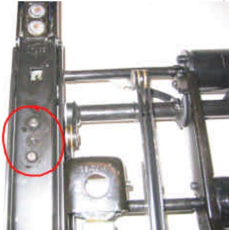
Jetzt lässt sich der Teil der Sitzschiene, der normalerweise dem Fahrzeugboden am nächsten ist, nach oben verschieben (roter Pfeil). Dadurch wird unten die große Torx T45 Schraube sichtbar (grüner Kreis) – ebenfalls lösen:
