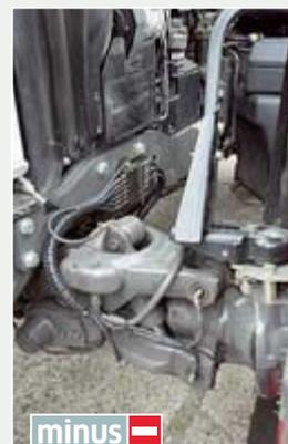
*Die gefederte Vorderachse hat alleine 24 Schmierstellen. Da sind die zwei Verteilerblöcke links und rechts für rund 600 Euro Pflicht.*
