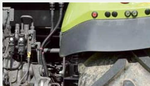
Die Kupplungen im 530 Cebis und 620 CIS (ganz links) haben einen Entlastungshebel und sind unter Druck kuppelbar. Die externe Bedienung von Hubwerk, Hydraulik und Zapfwelle ist vollständig. Der 620 C hat nur einfache Steckkupplungen, eine externe Bedienung fehlt. Und die Zapfwelle kann nur aus-, aber nicht eingeschaltet werden.
