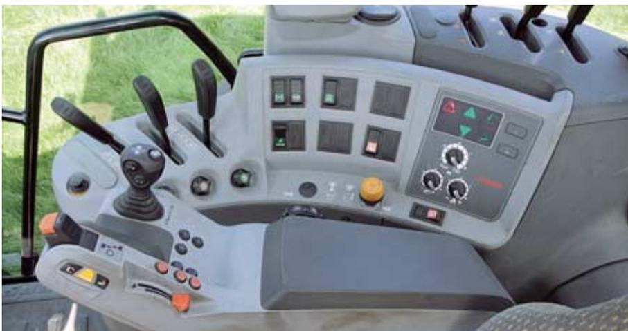
*Dem Arion 620 CIS fehlen der Monitor (und natürlich die Knöpfe fürs Vorgewende-Management seitlich in der Armlehne), dafür sitzen hier drei mechanische Ventile. Die elektrischen Ventile vom Kreuzhebel werden im Armaturenbrett eingestellt.*
