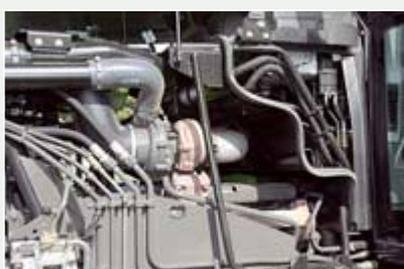
Ganz oben der Vierventilmotor mit externer, gekühlter Abgasrückführung samt Turbolader mit variabler Geometrie im 530 Cebis und 620 CIS. Im Bild darunter der „starre“ Turbo im 620 C.
