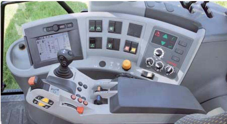
*Die größten Unterschiede zwischen den drei Modellen findet man auf der rechten Konsole. Der Arion 530 Cebis hat die komplette Bedienarmlehne mit dem kleinen „Drivestick“ zum Schalten, den elektrischen Steuergeräten und dem Cebis-Monitor samt Vorgewende-Management.*
