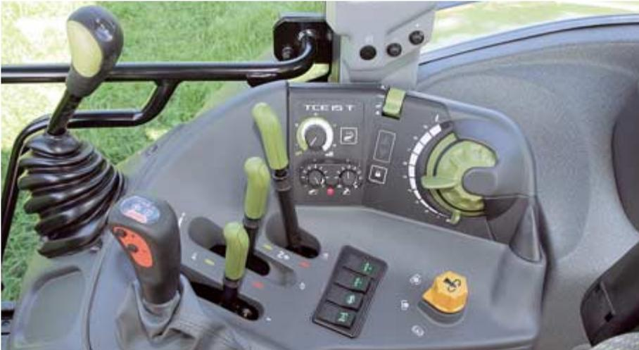
Beim Arion 620 C ist alles beim „Alten“ geblieben: Handgashebel mit Knöpfen zum Schalten, mechanische Betätigung der Ventile und Hubwerksbedienung über die TCE 15 T.
