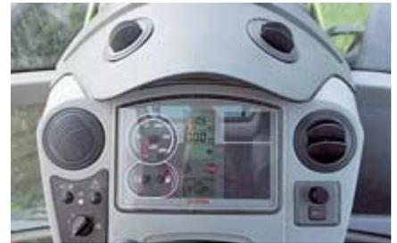
Das Armaturenbrett ist auf den ersten Blick gleich. Beim CIS gibt es aber rechts den Drück-Dreh-Schalter, um bis zu sieben Funktionen zu schalten: vom Hektarzähler über sämtliche Einstellungen der Schaltautomatik und Steuerventile bis hin zur Dieserverbrauchsanzeige. Links die Lüftungsbedienung.
