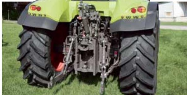
*Im Heck ist alles an seinem Platz: Luft- und Elektroanschlüsse schön hoch und von links zugänglich, gerade ausgerichtete Ölschlüsse auf beiden Seiten. Das Hubwerk ist bei allen drei Arion fast identisch, die durchgehende Hubkraft ist mit 4,3 bzw. nur 4,1 t schon mal knapp. Die Hydraulikleistung mit der Axialkolbenpumpe ist dagegen sehr gut.*
