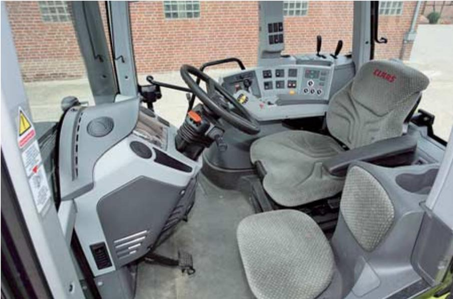
Die Kabine ist geräumig und hat eine ordentliche Sicht. Der Arion 530 Cebis (Bild) ist mit gut 72 dB(A) angenehm leise, der 620 C mit fast 78 dB(A) überdurchschnittlich laut.
