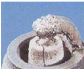
**Erscheinungsbild:** Mittelelektrode angeschmolzen, Masselektrode gleichzeitig stark angegriffen.
