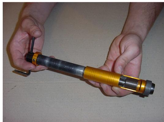
5. Die Spindel drehen, um die ersten Windungen des Gewinde-Einsatzes in die Gerätespitze einzuführen. So lange drehen, bis die erste Windung an der Vorspannpatrone sichtbar ist.
