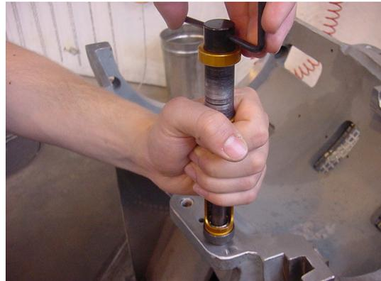
7. Nun den Gewinde-Einsatz mit der Spindel in das Aufnahmegewinde drehen, bis der Einsatz etwa eine halbe Windung unter der Oberfläche des Materials zu liegen kommt.
