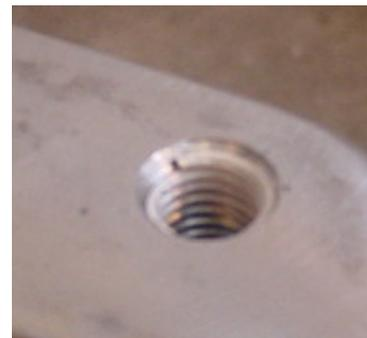
8. Die Entfernung des Mitnehmers soll mit dem Zapfenbrecher erfolgen, um zu vermeiden, dass die unterste Helicoil-Windung aus dem Gewinde herausgedrückt wird.
