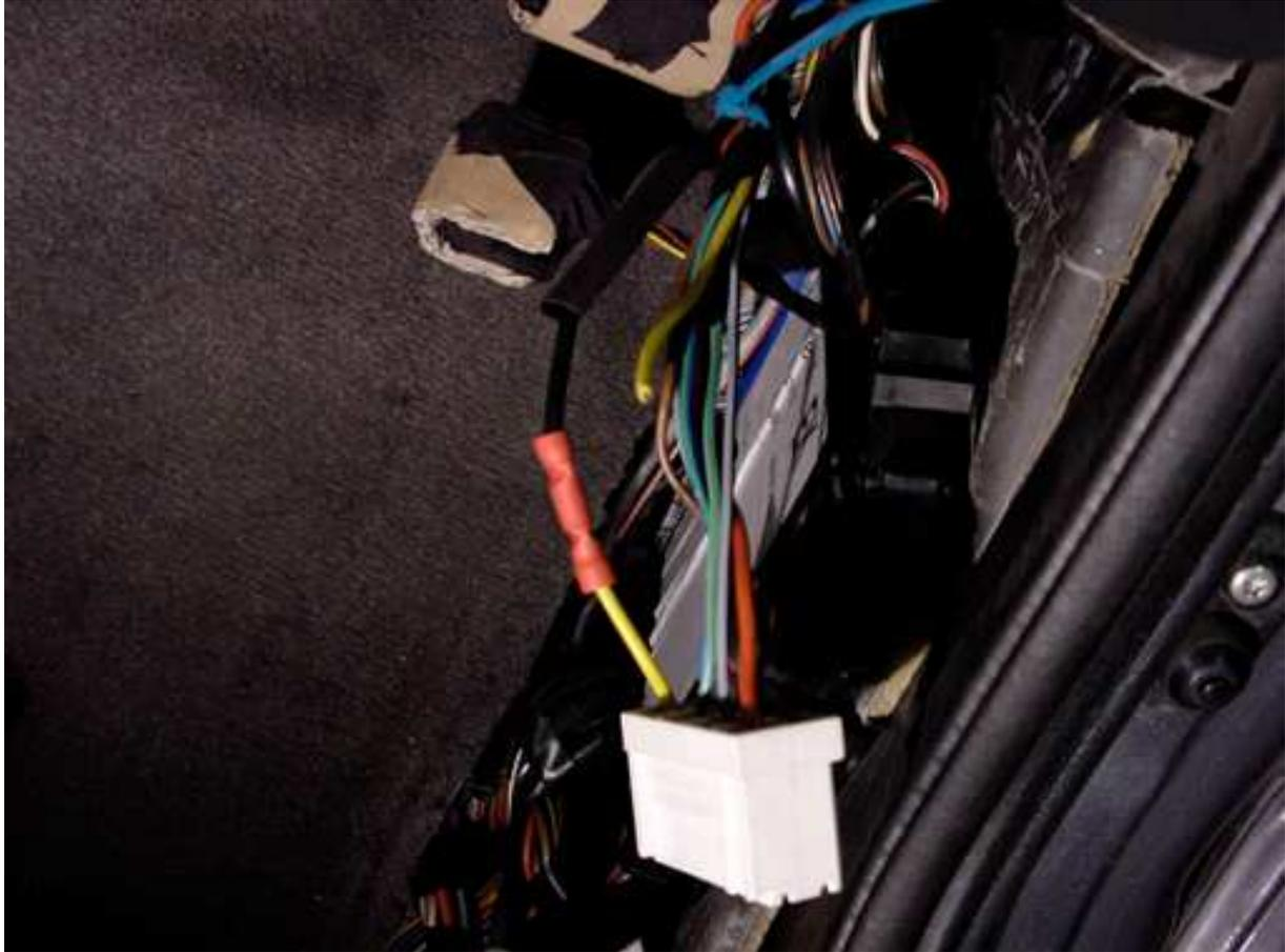
Im Sicherungskasten auf der Rückseite von F16 mit einer Klemme das Kabel von K59 auf die einzelne, starke Leitung, dazuklemmen (auf der anderen Seite sind zwei abgehende Leitungen zu je einem NS)
