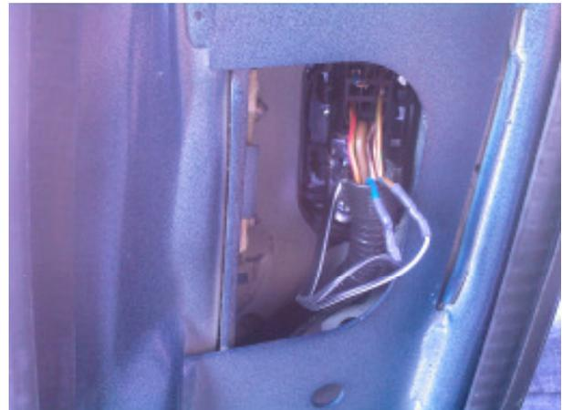
Das Lautsprecherkabel endet in der B-Säule an der Steckverbindung zur Tür (Auf dem linken Bild, bilden die beiden obersten Adern das Lautsprecherkabel). Die Rückseite des Steckers an den Lautsprecherkontakten ist hohl.
