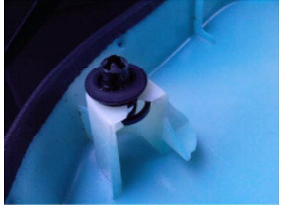
**Es kann durchaus passieren, dass ein Clip zerbricht. Die Clips kann man günstig bei VW nach kaufen. Auch soll darauf geachtet werden, ob Clips während der Demontage auf den Boden fallen.**
