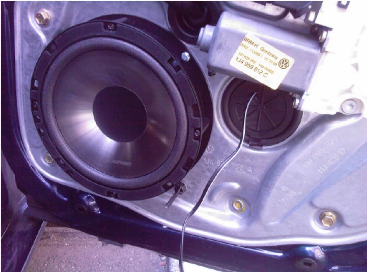
Ich bin mir nicht sicher ob ein Einbauadapter zwingend erforderlich ist, allerdings sollte er schon alleine aus optischen Gründen eingebaut werden, da man sonst durch die Lautsprecherabdeckung der Türverkleidung auf das blanke Blech der Tür sehen kann. Der Lautsprechereinbauadapter war in meinem Set dabei.
