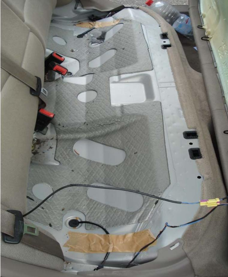
2. abgeklebte Löcher für Isofix-Halterung freischneiden
