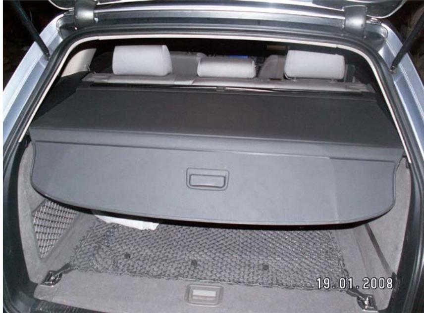
Hier die Ausgangssituation. Die Klappe hängt hinten schlaff herunter und ist kurz vorm raus springen.
