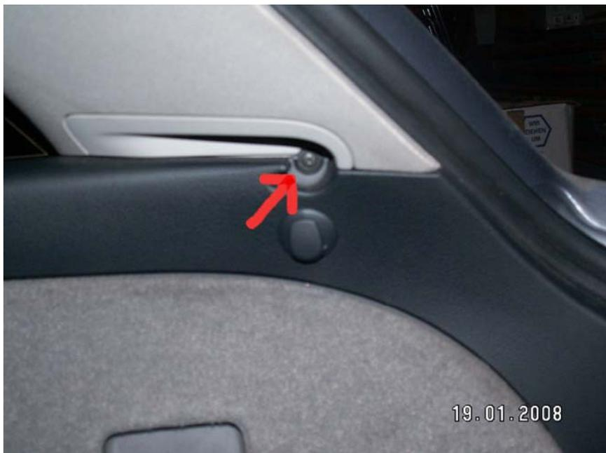
Schritt 2: Jetzt müsst ihr vom Einsatz das die Folie vom Klebeband abziehen. Der Einsatz wird dann einfach in das Loch geschoben in der vorher die Schraube war. Nun die neue Schraube rein und mit dem T20 Torx-Schraubendreher festziehen.
