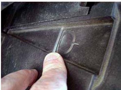
Zum Herausnehmen des Batteriedeckels drückt man einfach auf die beiden Knöpfe links und rechts am Deckel.
