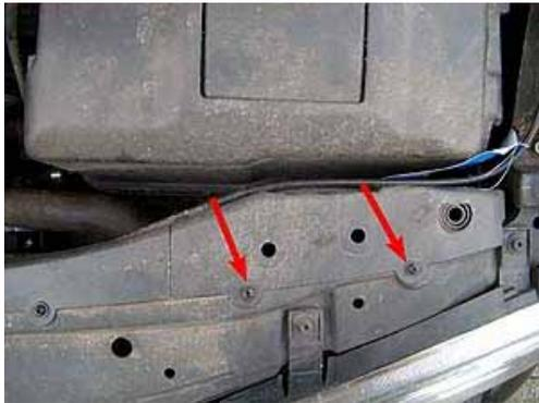
Die Fahrerseite ist ein bisschen verbauter. mit einem Kreuzschlitzschraubenzieher werkeln wir erstmal die beiden Schrauben weg...
